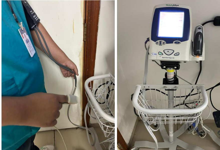
Ilustración 22: Mantenimiento preventivo a monitores de signos vitales
