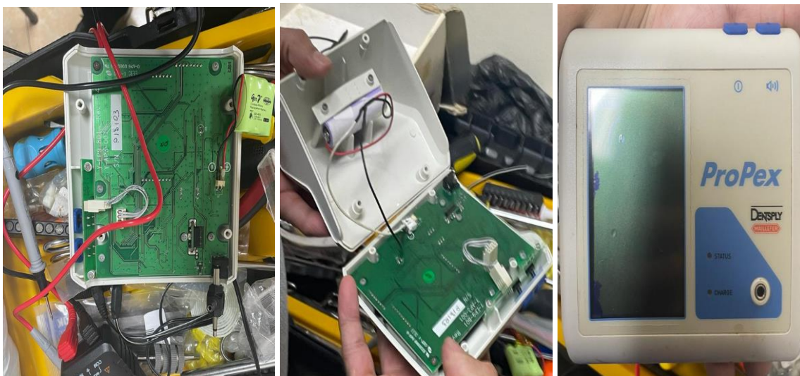
Ilustración 54: Mantenimiento correctivo a localizador de ápices
