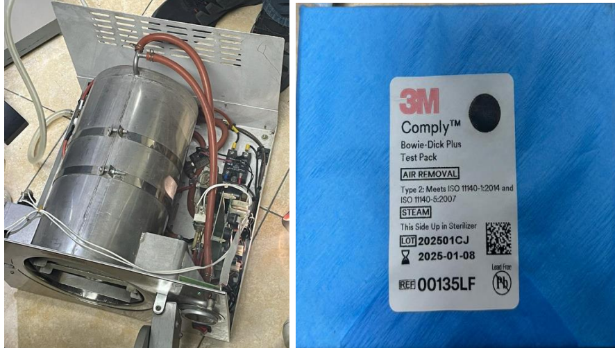
Ilustración 70: Revisión y diagnóstico de autoclave odontológico
