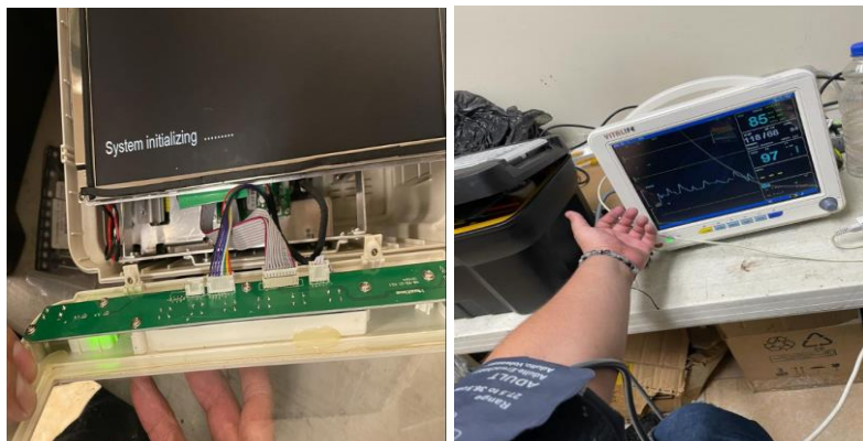
Ilustración 36: Mantenimiento correctivo a monitor de signos vitales pediátrico Vitalife
