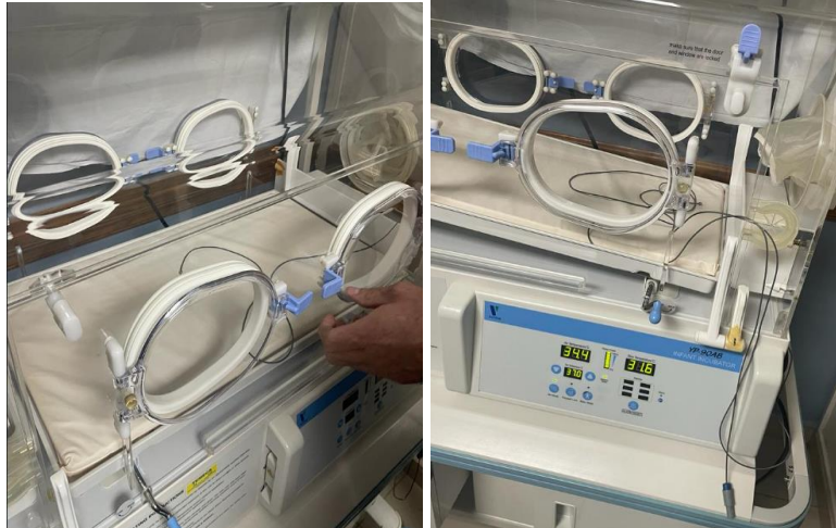
Ilustración 48: Actualización de sensores y desarrollo de pruebas en incubadora neonatal YP-90AB
