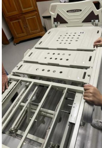
Ilustración 64: Mantenimiento preventivo a cama hospitalaria Joson Care
