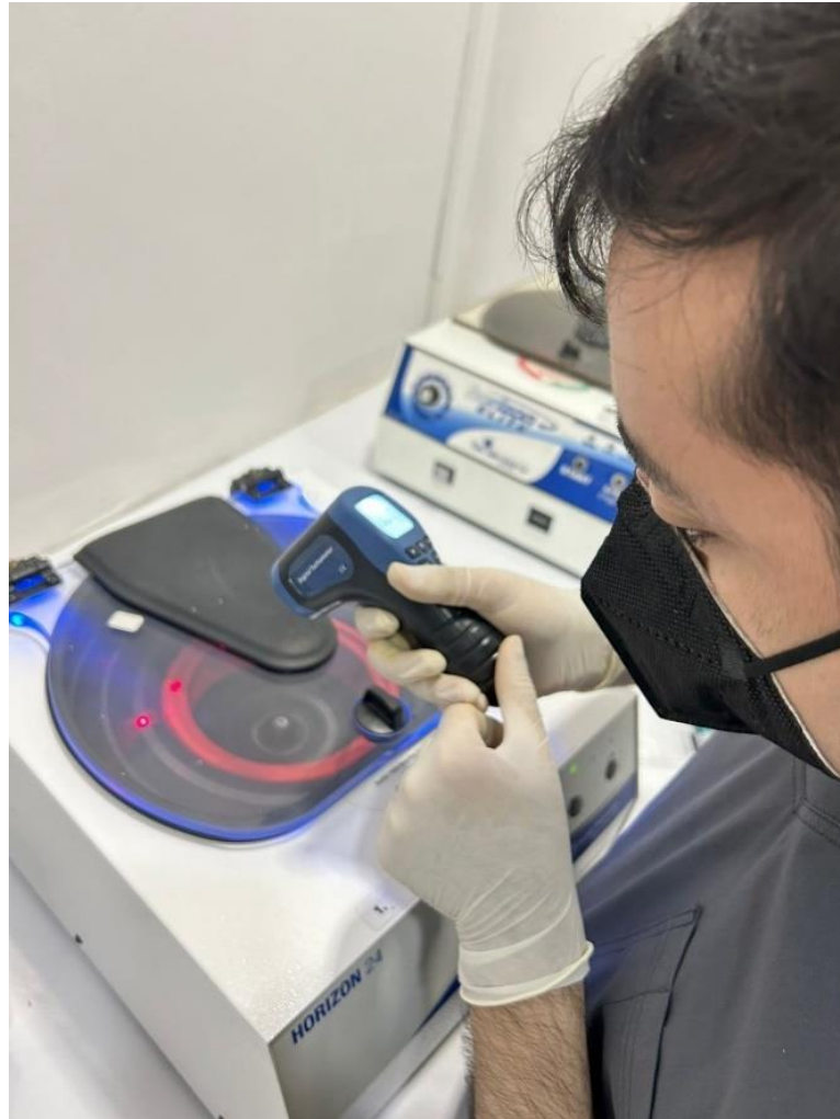
Ilustración 33: Prueba de las revoluciones con tacómetro en centrífuga
