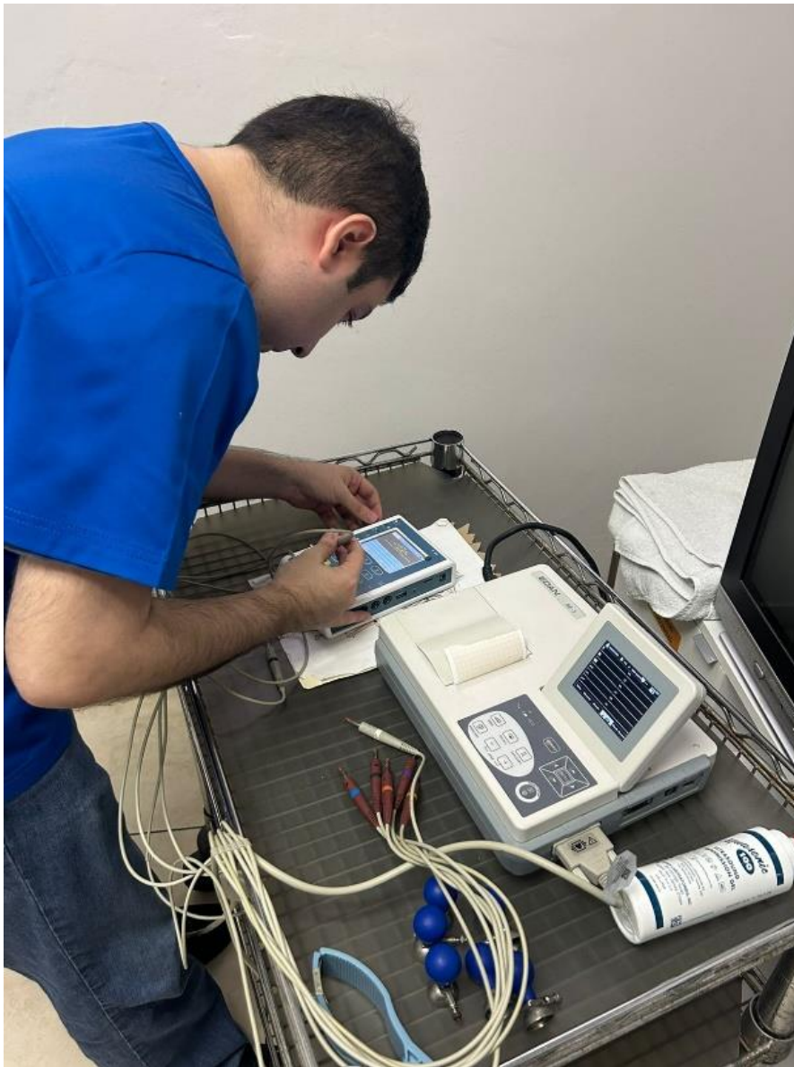
Ilustración 111: Revisión de electrocardiógrafo que no mostraba señal en el equipo
