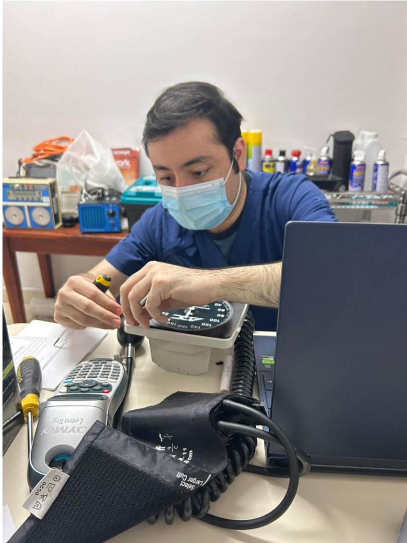
Ilustración 118: Calibración de esfigmomanómetro
