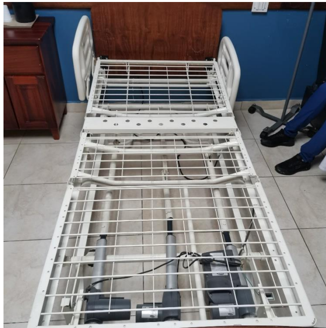
Ilustración 20: Limpieza y revisión de movimiento de camillas hospitalarias
