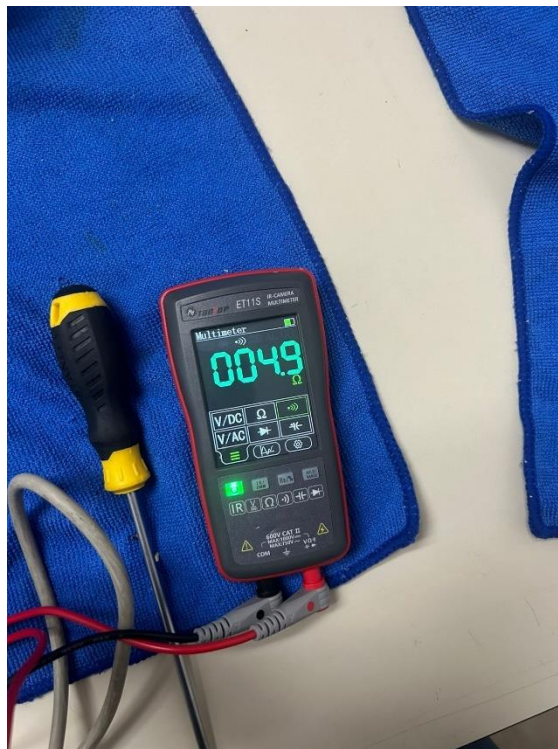
Ilustración 29: Prueba de continuidad del equipo
