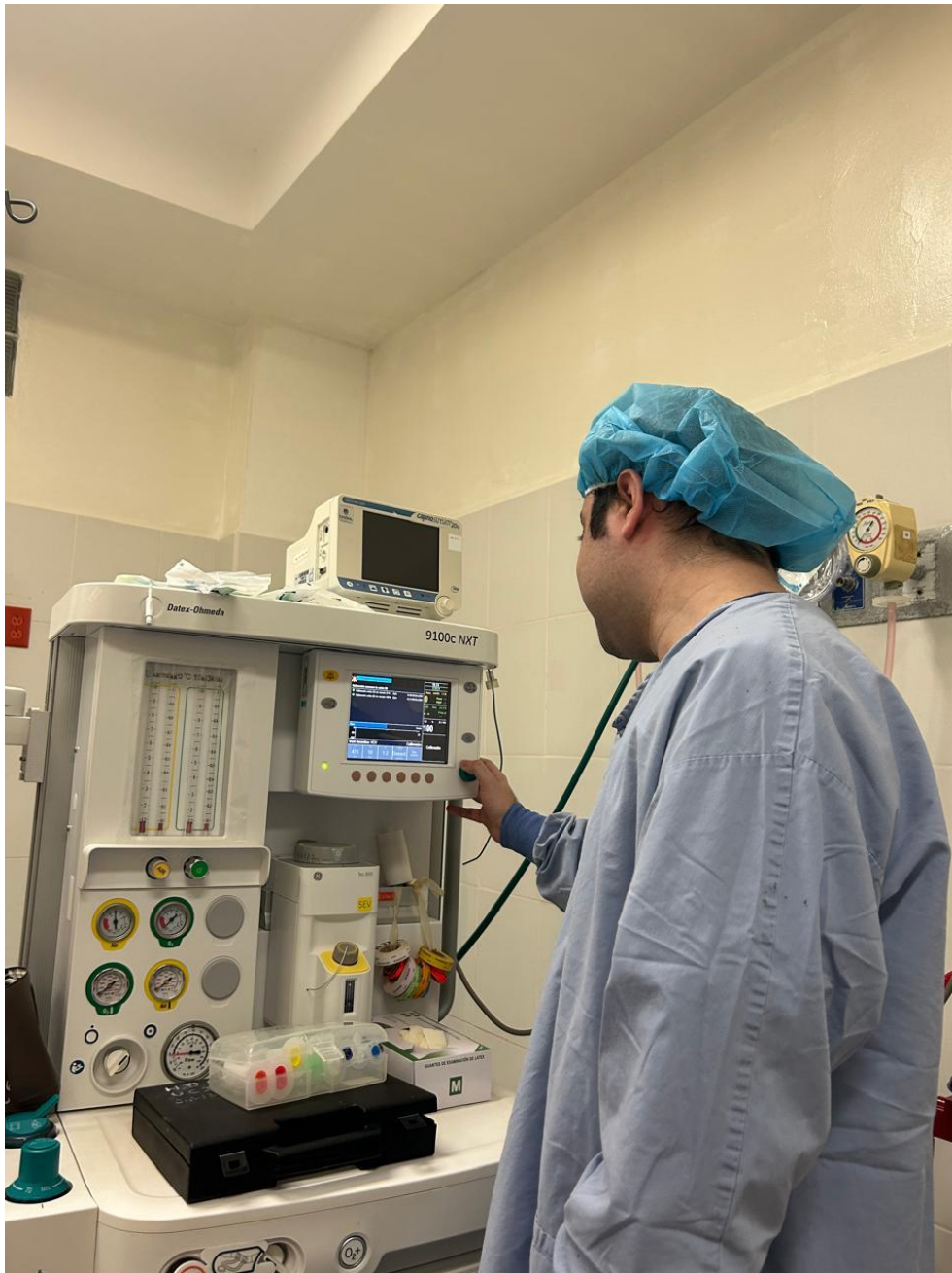
Ilustración 117: Calibración del módulo de aire en máquina de anestesia
