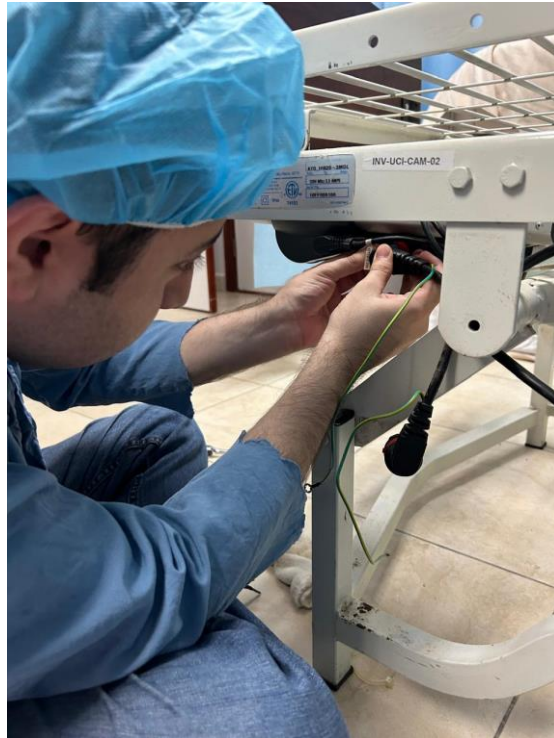
Ilustración 23: Cambio de pistón de piernas de camilla en UCI
