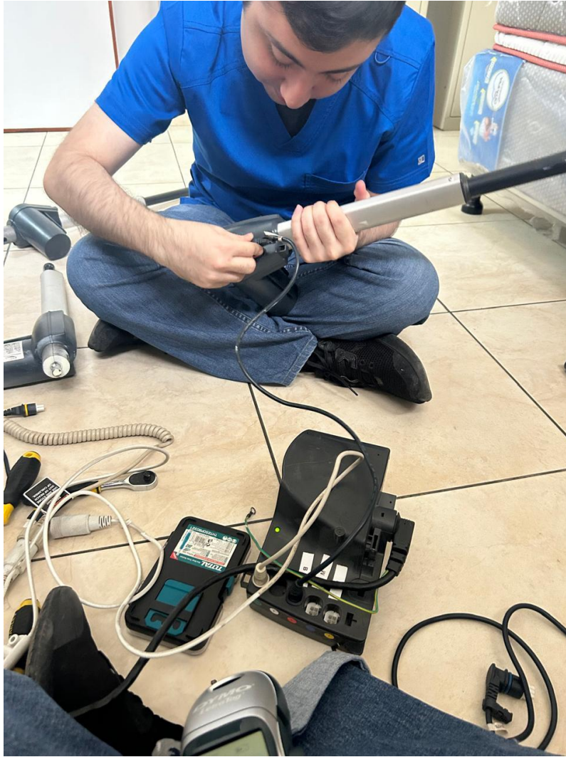
Ilustración 116: Prueba de pistones de camillas
