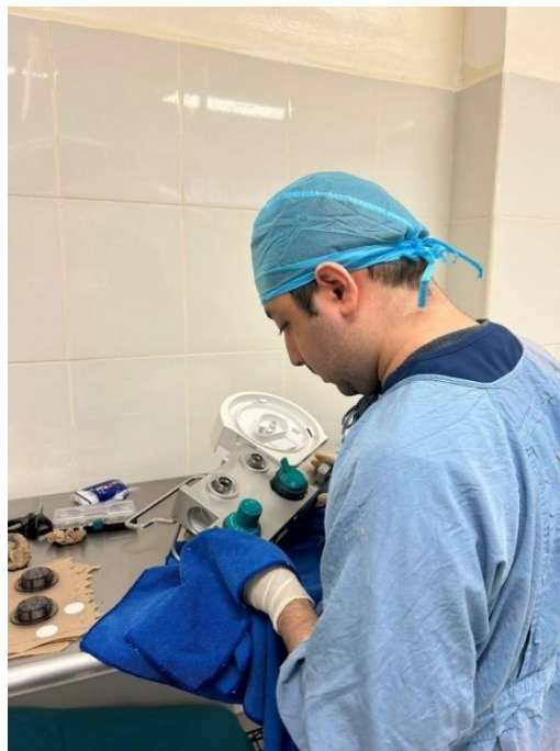
Ilustración 27: Limpieza del módulo de ventilación
