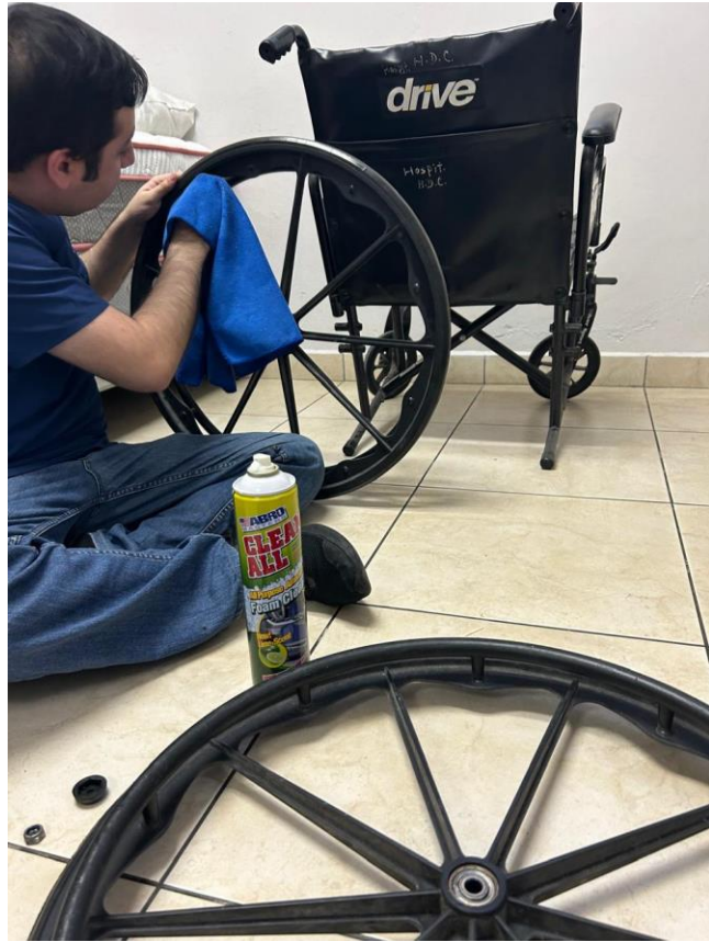
Ilustración 44: Limpieza de ruedas de la silla
