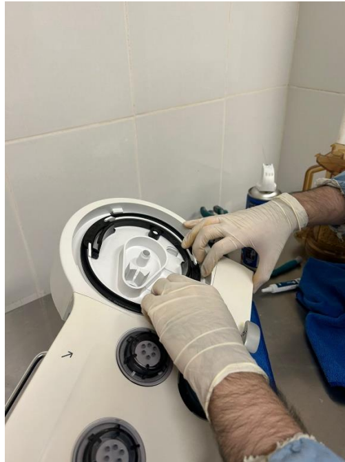
Ilustración 26: Limpieza del fuelle de máquina de anestesia
