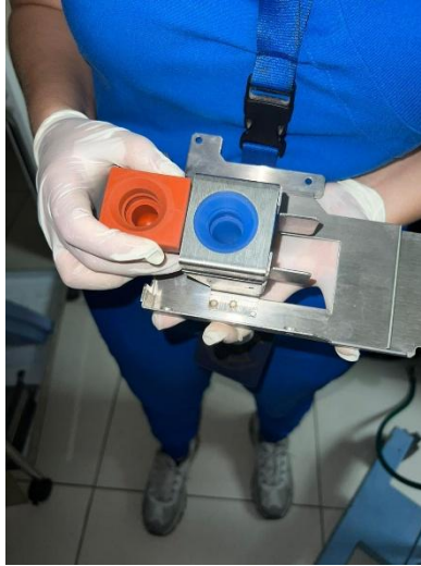
Ilustración 30: Comparación entre empaques de toma exhalatoria.
