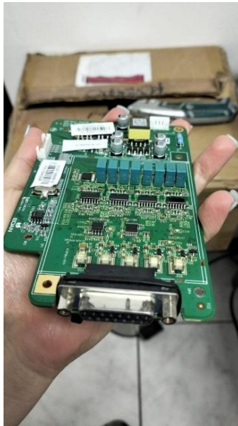
Ilustración 10: Placa electrónica perteneciente al módulo de recepción de señales del ECG.
