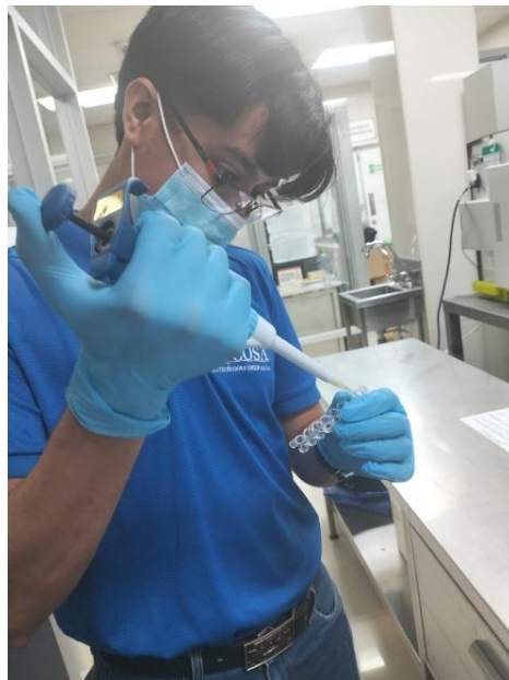
Ilustración 15: Verificación de los volúmenes arrojados por la sonda del mago 4.
