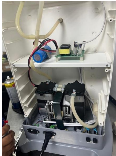
Ilustración 36: Succionador de secreciones sin carcasa trasera.
