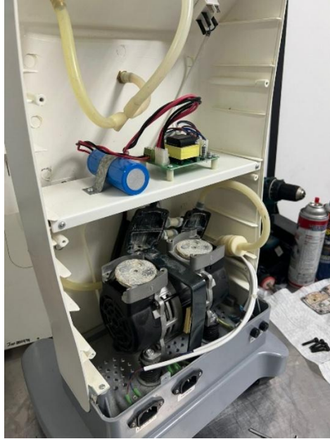
Ilustración 19: Aspirador de secreciones - componentes internos
