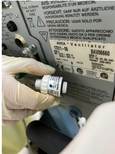
Ilustración 28: Celda de oxígeno de ventilador mecánico.
