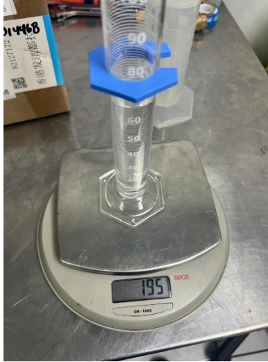
Ilustración 37: Muestra de volumen infundido en calibración de bomba de infusión.
