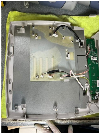
Ilustración 22: Cambio de carcasa de monitor fetal.
