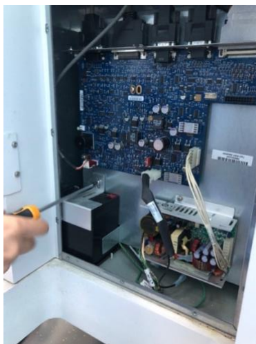
Ilustración 93. Ubicación de batería en máquina de anestesia
