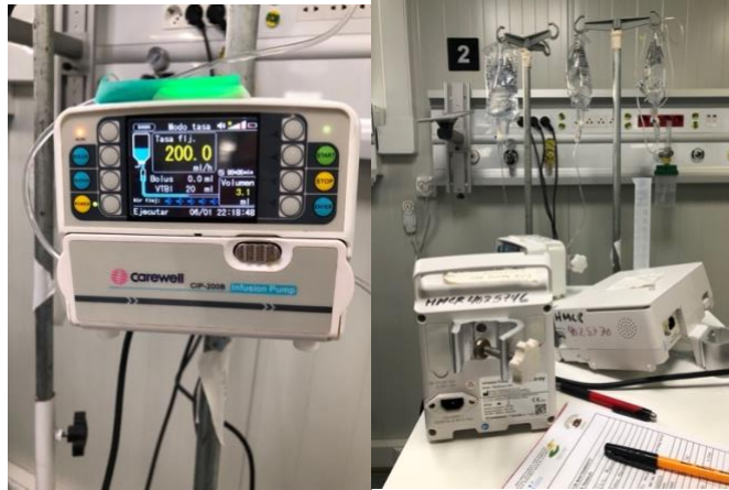
Ilustración 73. Pruebas de funcionamiento a bombas de infusión
