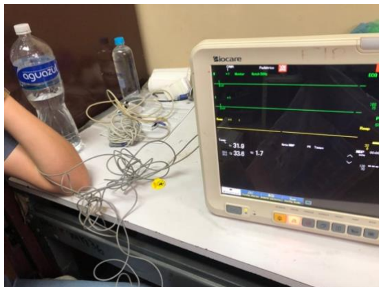
Ilustración 100. Revisión de funcionamiento de sensores de temperatura.
