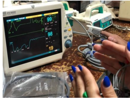
Ilustración 42. Corroboración de funcionamiento msv PM-9000
