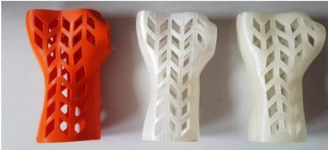
Figura 9. Órtesis fabricadas verticalmente a partir de PLA propuestas por (Górski et al., 2020).
