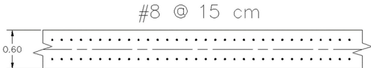
Ilustración 38 - Detalle de la losa exterior lateral
