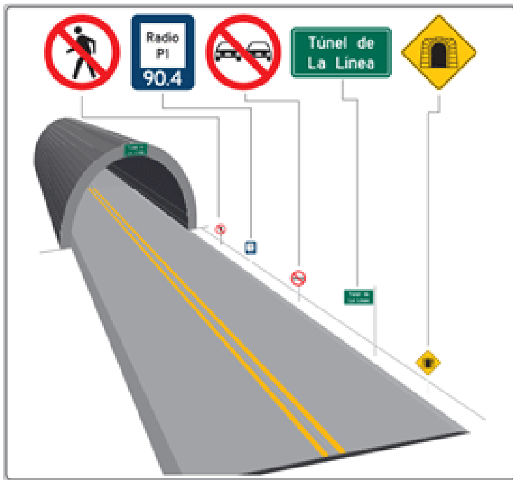
Ilustración 39 - Señalización próxima a la entrada del túnel
