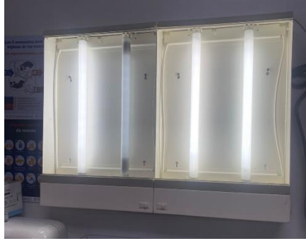
Ilustración 26. Negoscopio con una de sus lámparas averiada
