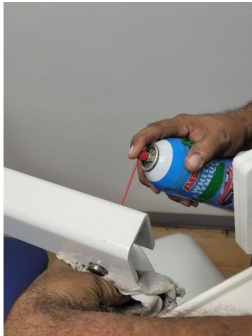
Ilustración 37: Lubricación de extremidades de unidad odontológica
