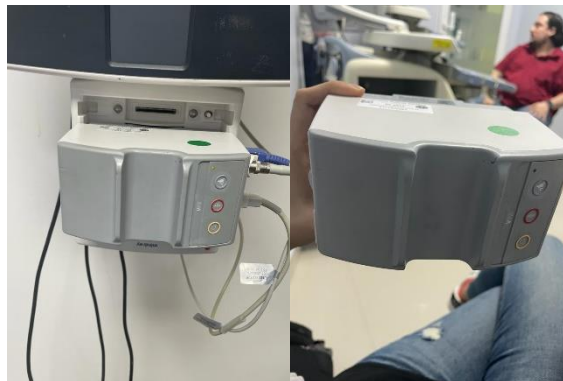
Ilustración 63- Cambio de módulo del MSV de la sala de emergencias.
