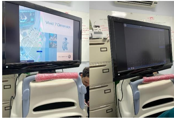
Ilustración 55- Pruebas de cambio de monitor para encontrar la falla del equipo.
