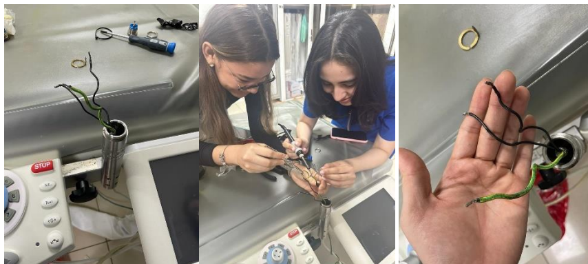
Ilustración 75- Reparación de palanca que permite los movimientos de la mesa del angiógrafo.
