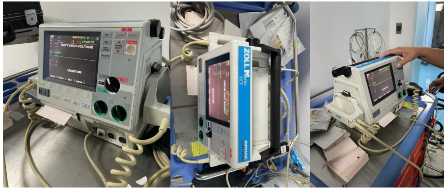
Ilustración 36- Desfibrilador con falla en la batería y cable de alimentación.
