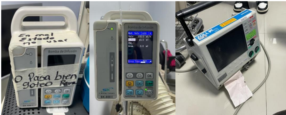
Ilustración 82- Bomba de infusión y desfibrilador en mal estado.
