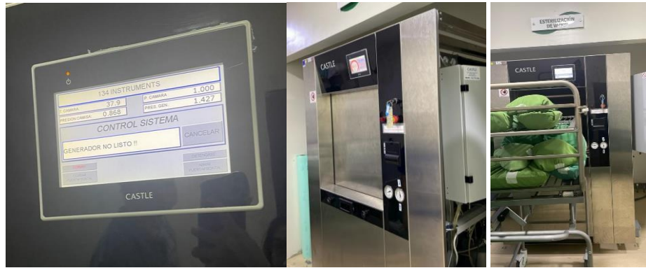
Ilustración 74- Revisión de la autoclave por fallo en el generador.
