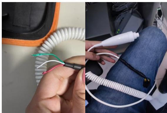
Ilustración 34- Cables reventados del disparador del equipo de rayos X.
