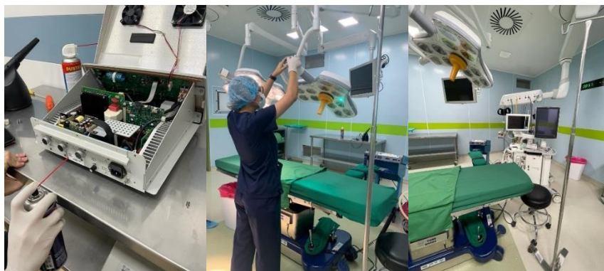
Ilustración 22- Mantenimiento preventivo en electrocauterios, lámparas y mesas quirúrgicas.
