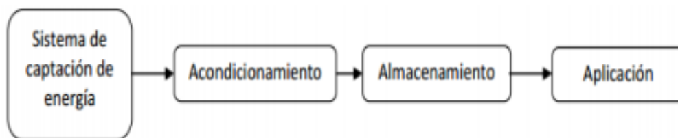
Ilustración 4.1: Esquema de un sistema Energy Harvesting
