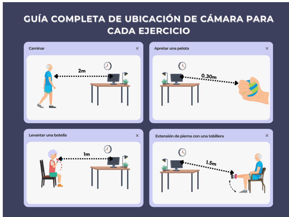
Ilustración 5: Parte 1 de guía completa de ubicación de cámara y distancias recomendadas para cada ejercicio físico.
