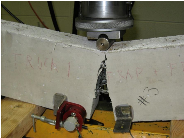
Figura 4.1. Ejemplo del comportamiento post agrietamiento de un espécimen de viga, muescado, de un FRC con un volumen de macrofibras sintéticas de 0.43%.
