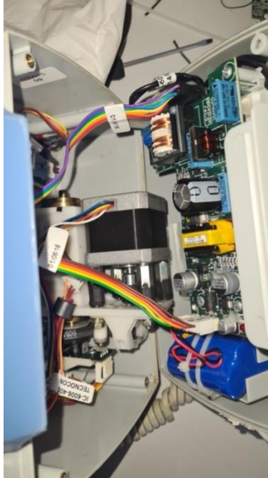
Figura 16 - Interior de Bomba de Infusión Samtronic Icatu 5
