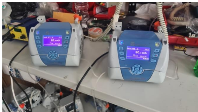
Figura 25 - Pruebas de Rendimiento, Bombas de Infusión Icatu S
