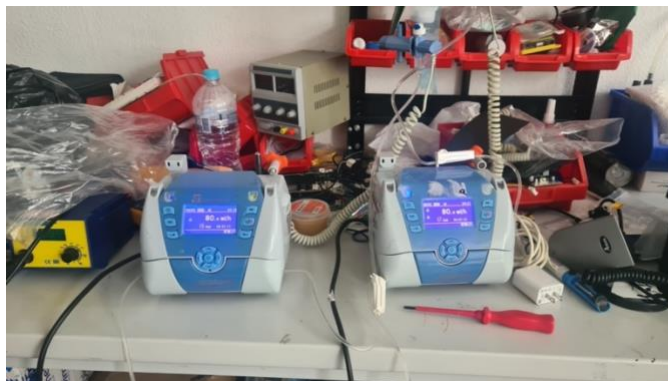
Figura 21 - Calibración de Bombas de Infusión Samtronic Icatu S
