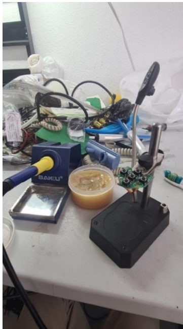
Figura 51 - Reparación de Módulo de Teclado, Bombas de Infusión Icatu S
