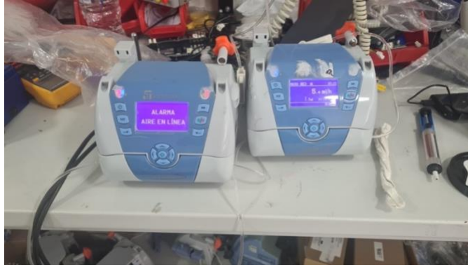
Figura 19 - Pruebas de Rendimiento, Bombas de Infusión Icatu S
