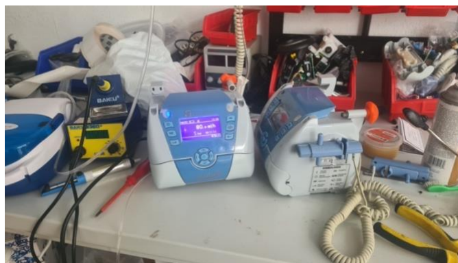
Figura 47 - Bombas de Infusión Icatu S, en calibración
