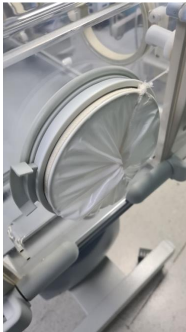
Figura 59 - Funda de Acceso Rápido Mal Instalada, NatalCare LX, HLMV, UCIN
