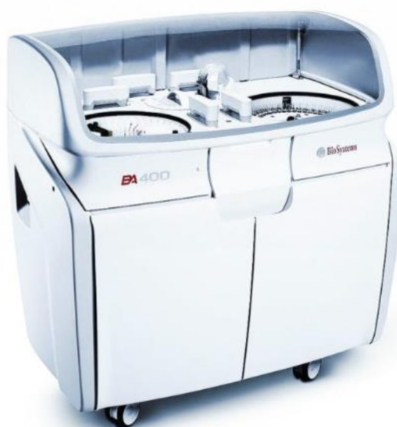
Ilustración 10 - Analizador de bioquímica automático BA400.
