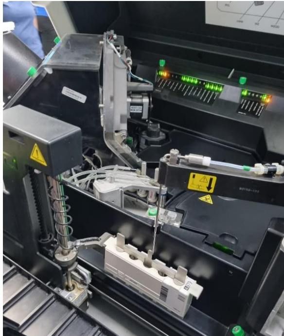
Ilustración 16 - Calibración de inyector en Architect i1000RS (HB).
