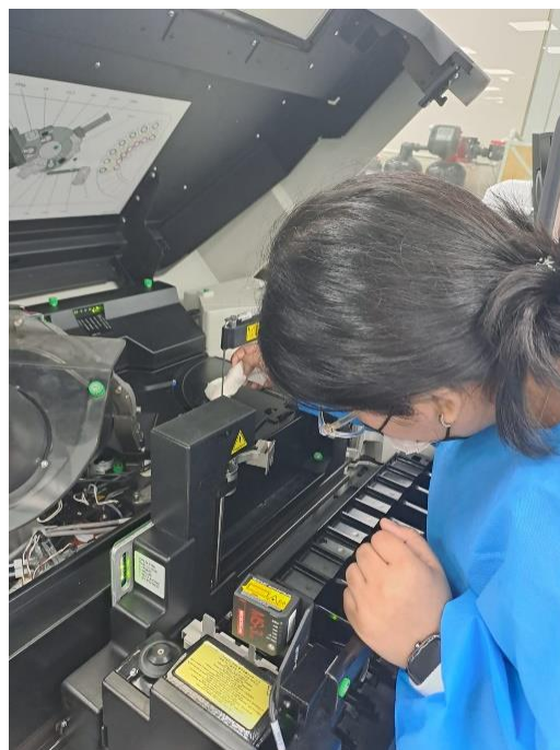
Ilustración 48 - Limpieza de Sonda de Pipeteo i1000SR #2 LBA.
