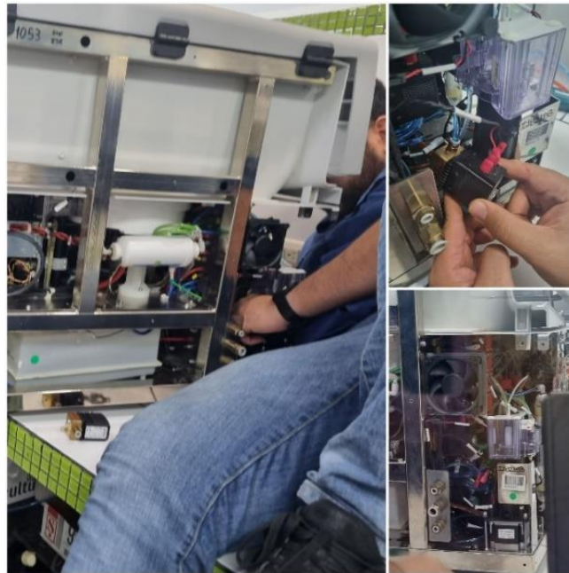
Ilustración 37 - Reemplazo de electroválvula en BA200 en LB.
