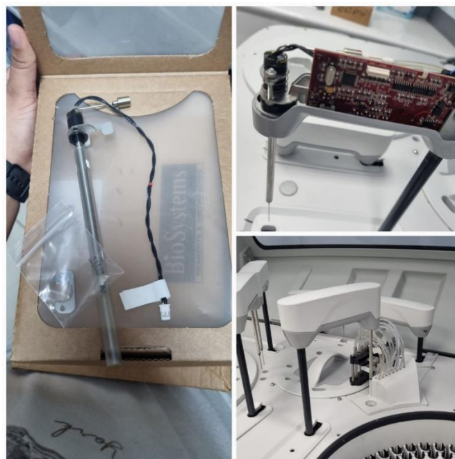
Ilustración 54 - Cambio y calibración de sonda en BA400 en HB.
