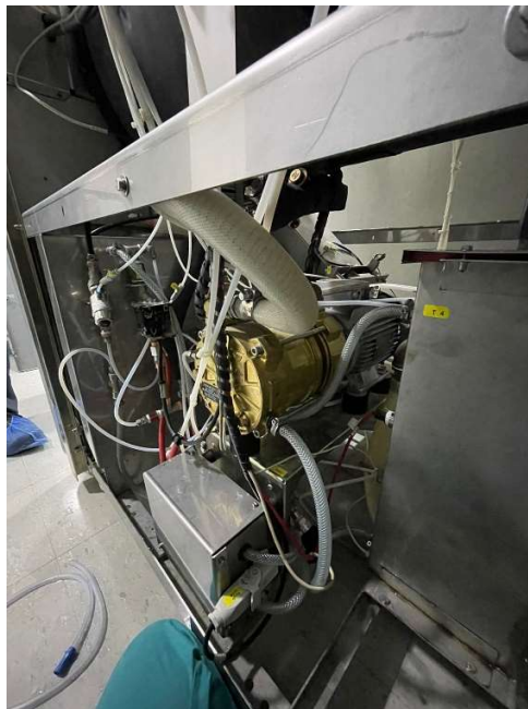
Ilustración 41 Bomba de agua en equipo de esterilización a baja temperatura
