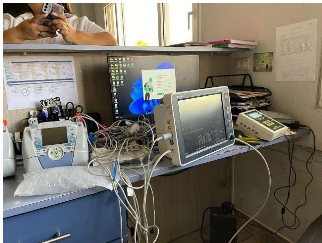
Ilustración 35 Monitor de signos vitales conectado al analizador Fluke.
