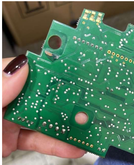
Ilustración 12 Corto circuito en placa principal de bomba de infusión
