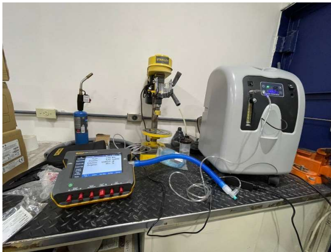
Ilustración 47 Analizador de oxígeno conectada al concentrador de oxígeno
