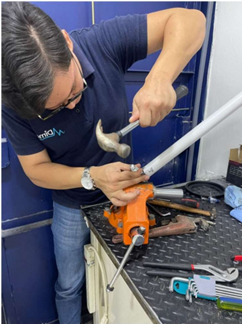
Ilustración 38 Reparación de brazo hidráulico
