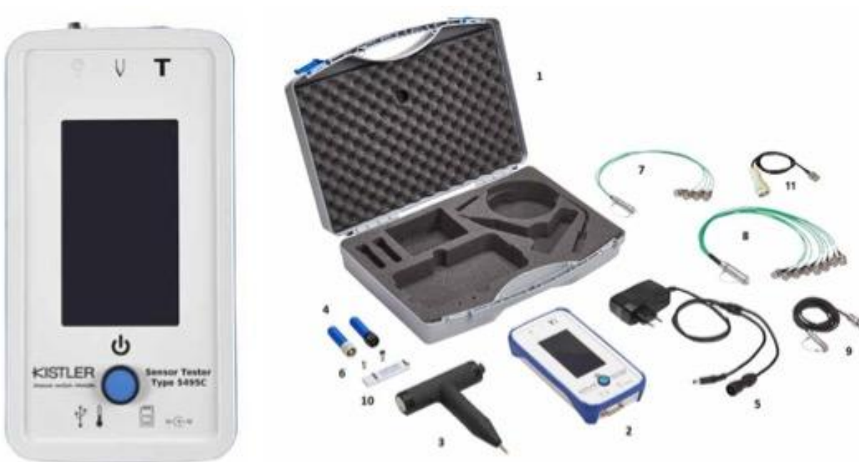
Figura 8.2.6 Probador de sensibilidad para sensores de presión
