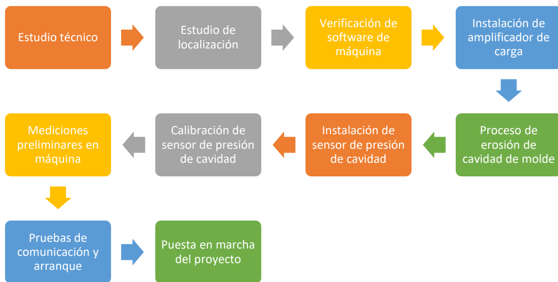
Figura 8.2.20 Diagrama de bloques del proceso de implementación
