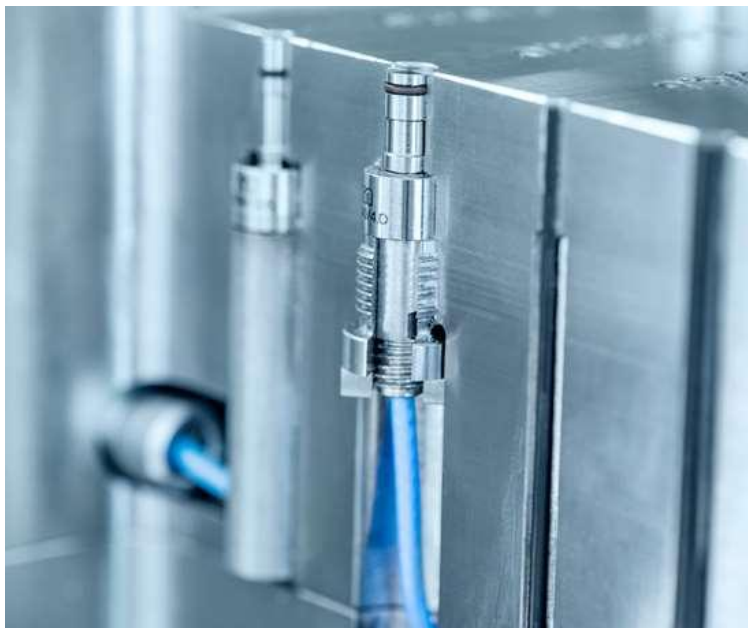
Figura 8.2.11 Sensor de presión de cavidad instalado
