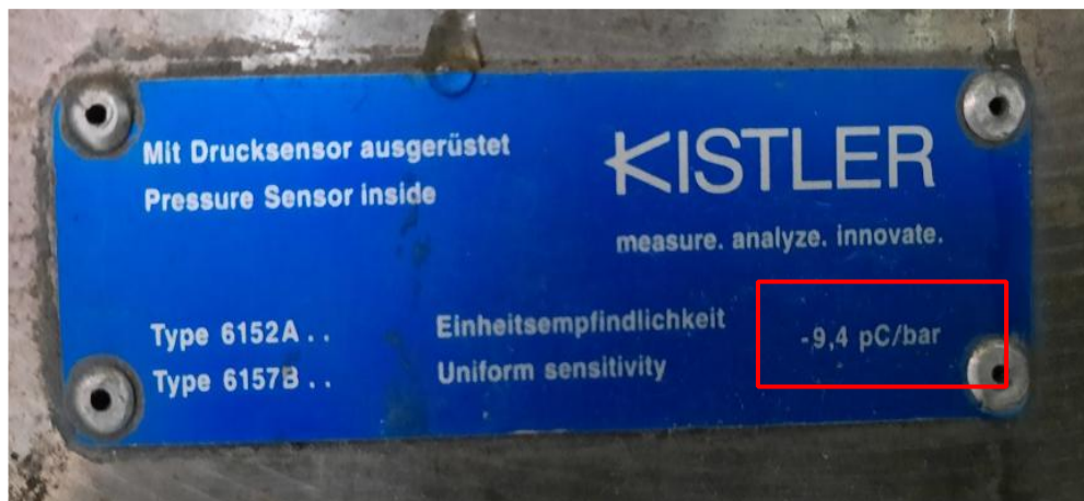
Figura 8.4.3 Placa de sensibilidad de sensor de presión
