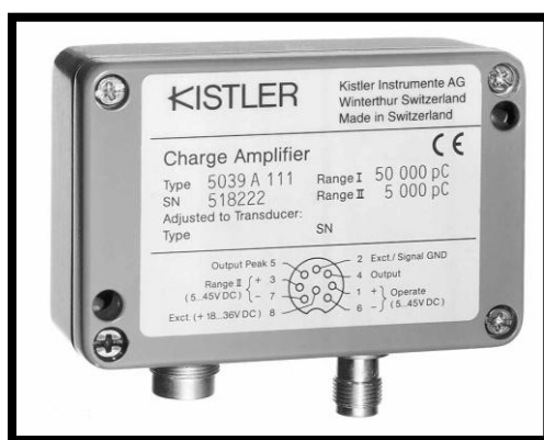
Figura 4.2.2 Amplificador de carga 5039A marca Kistler
