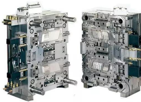
Figura 4.3.1 Molde de inyección típico de 2 caras
