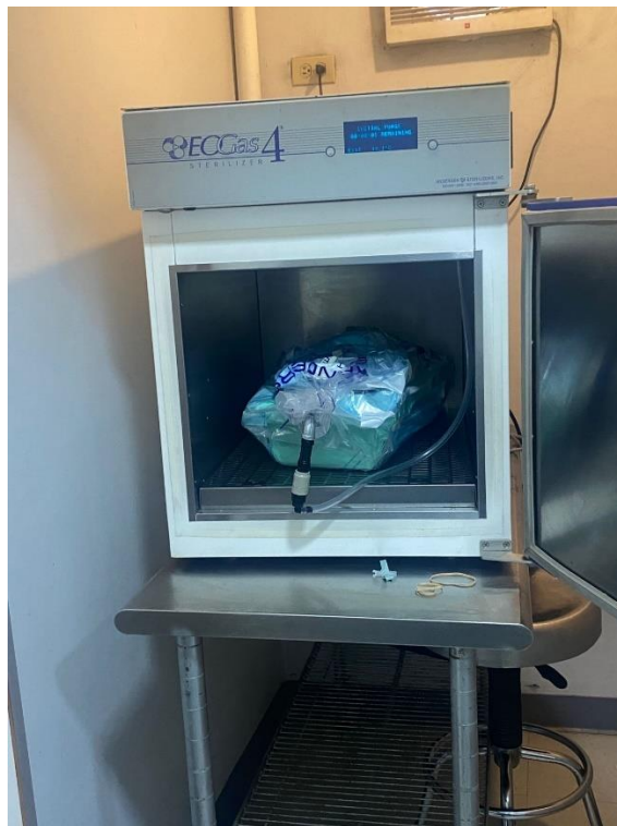
Anexo 12. Pruebas de la autoclave con la reparación del reductor en las mangueras
