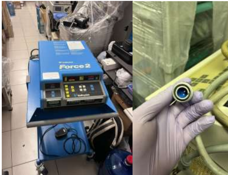
Ilustración 85- fallo de conexión de electrocauterio
