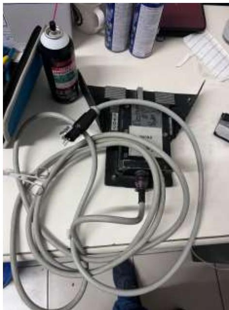
Ilustración 78- Pedal mono polar de electrocauterio
