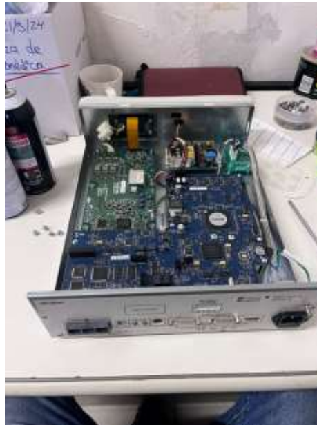
Ilustración 77- Tarjetas electrónicas de módulo stryker 1288
