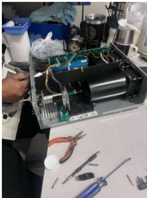
Ilustración 95- Fuente de luz reparación
