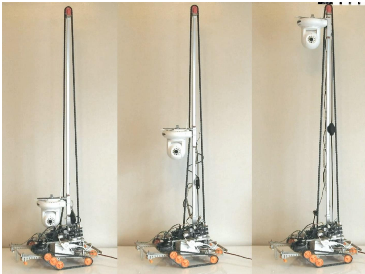
Ilustración 4.4.3: Robot de cámara IP controlado por web con Arduino
