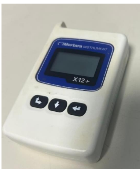
Ilustración 31: Trasmisor de ecg de prueba de esfuerzo
