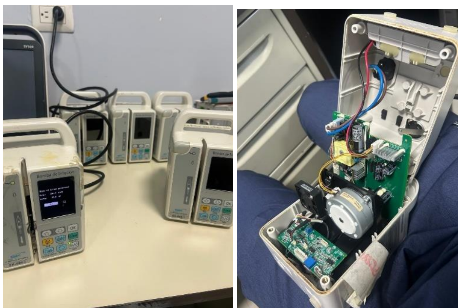
Ilustración 18: MP y MC a bombas de infusión
