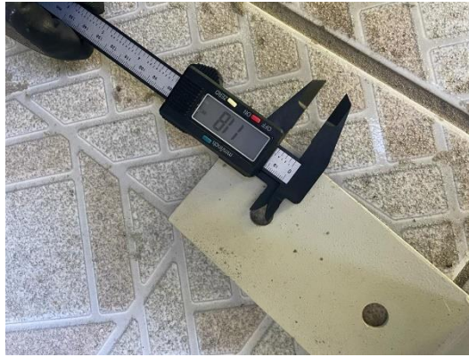
Ilustración 45 - Mediciones del diámetro del riel
