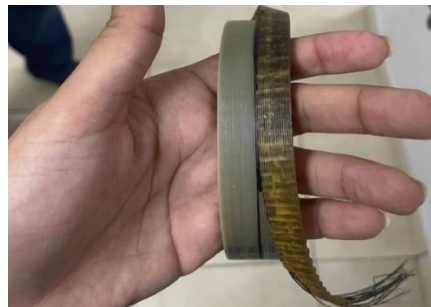
Ilustración 19 - Comparación entre la banda vieja con la nueva
