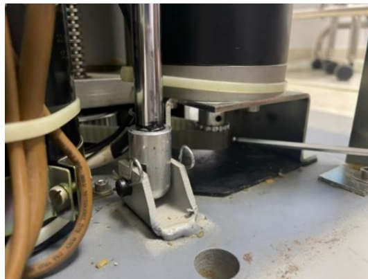
Ilustración 20 - Instalación de la banda
