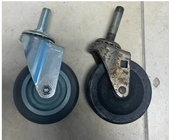
Ilustración 87 - Comparación entre rueda nueva y vieja
