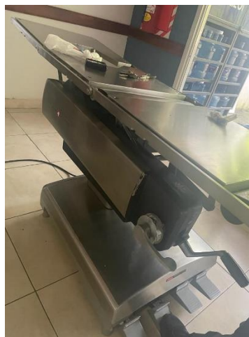
Ilustración 75 - Mesa quirúrgica realizando el movimiento de descender
