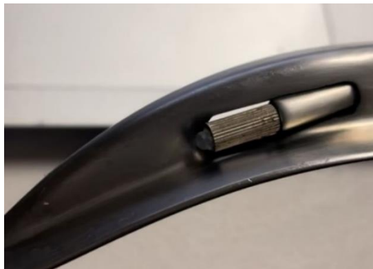
Ilustración 82 - LED de laringoscopio disfuncional
