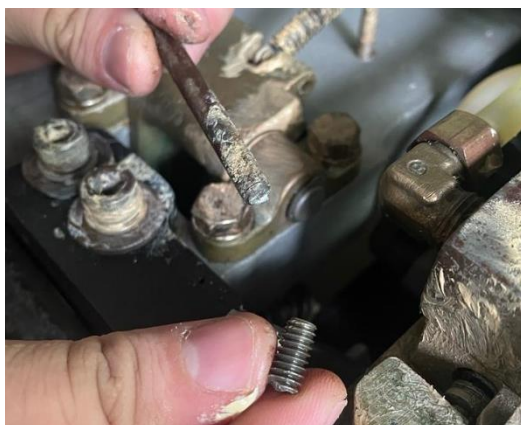
Ilustración 73 - Pieza de accionamiento quebrada
