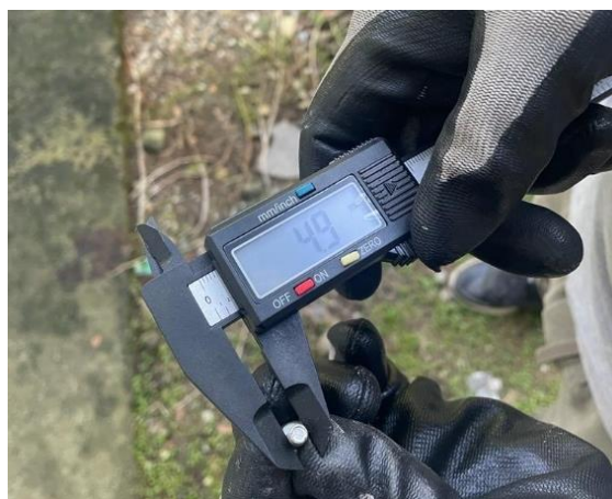
Ilustración 44 - Mediciones del diámetro de tornillos
