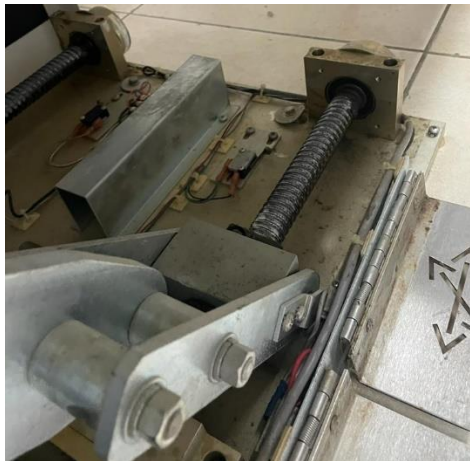
Ilustración 31 - Lubricación de la mesa de rayos X
