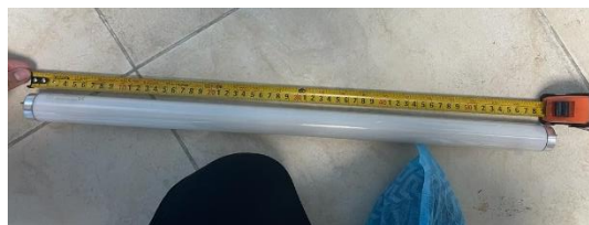
Ilustración 85 - Mediciones realizadas para cambio del tubo
