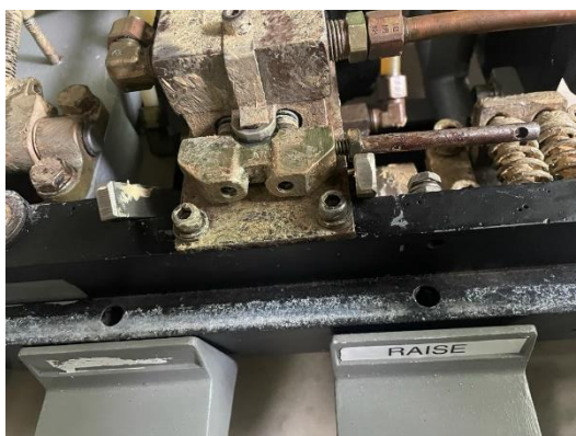
Ilustración 72 - Pieza faltante para el accionamiento del pedal de abajo
