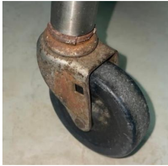
Ilustración 86 - Rueda desgastada del bacinete
