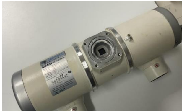
Ilustración 35 - Tubo de rayos X extraído
