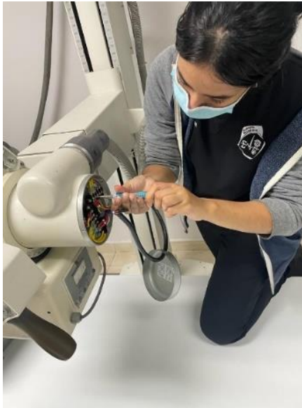
Ilustración 34 - Retirada del tubo de rayos X
