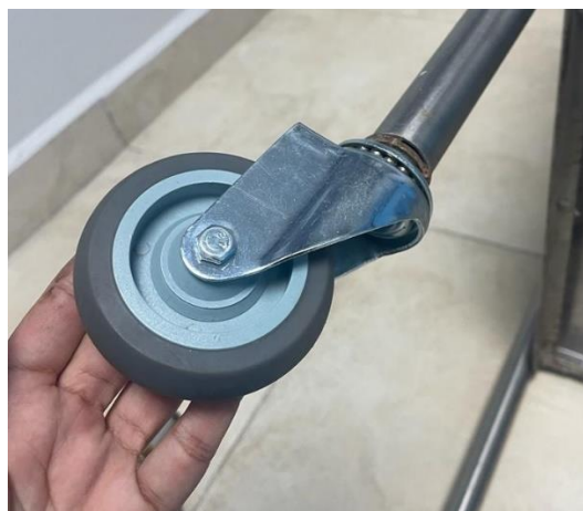
Ilustración 88 - Instalación de la rueda nueva en el bacinete
