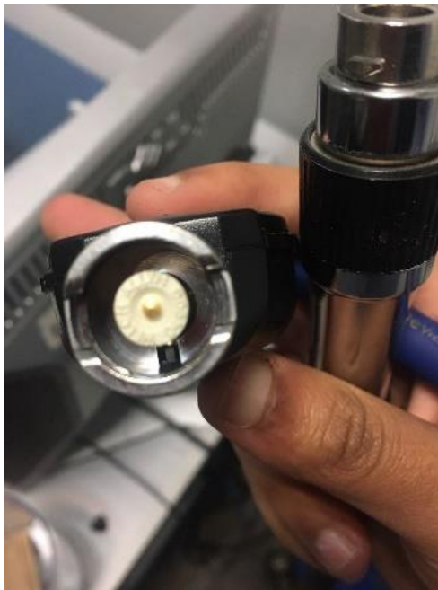
Ilustración 18-Remplazo de Bombillo 03000-U a otoscopio Welch Allyn
