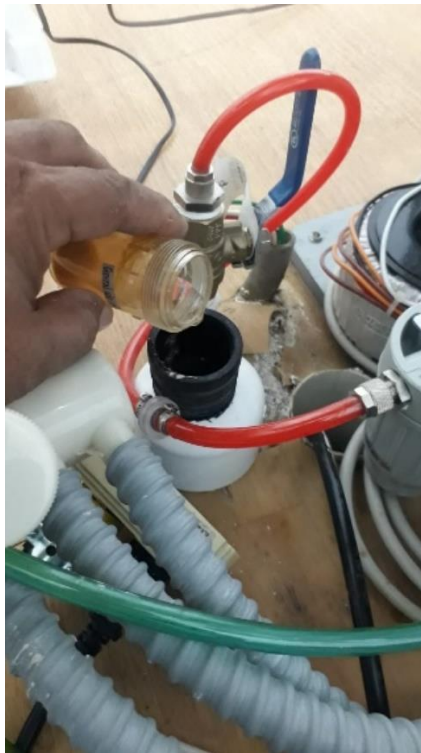
Ilustración 38-Mantenimiento Preventivo/Limpieza de filtro de residuos de agua de Unidades Odontológica
