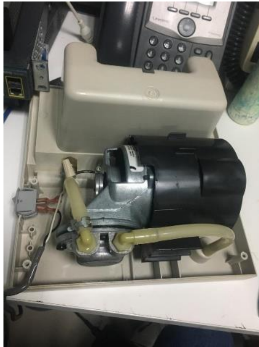
Ilustración 24-Mantenimiento Correctivo-Nebulizador DEVILBISS 5650D Pulmo Aide
