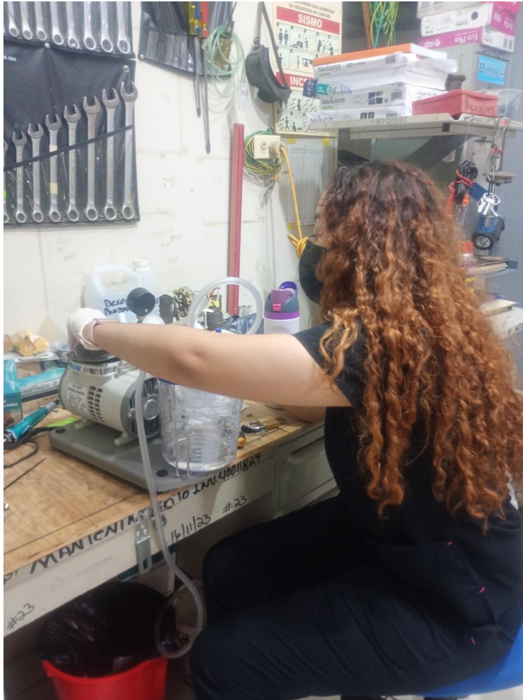
Ilustración 65. Limpieza y lubricación de succionador de fluidos
