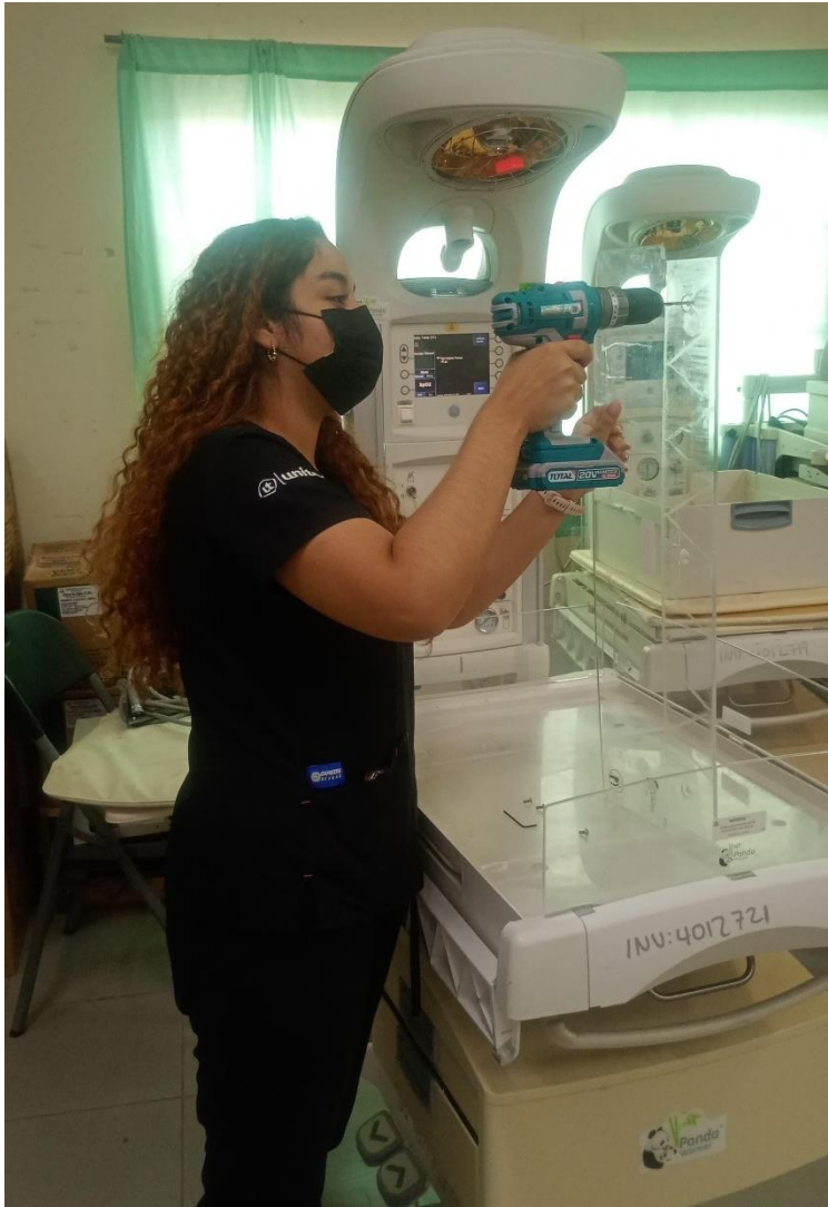
Ilustración 62. Mantenimiento correctivo de baranda de acrílico
