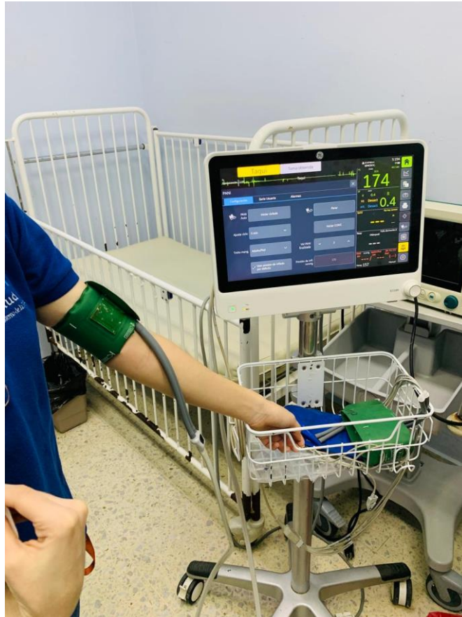
Ilustración 50. Prueba de manguera y brazaletes de NIBP
