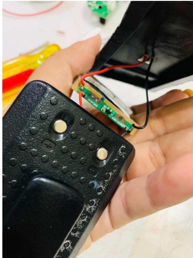
Ilustración 53. Cambio de batería de intercomunicador
