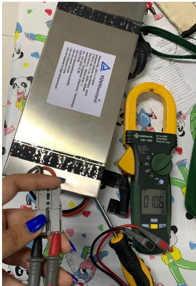
Ilustración 33. Revisión de estado de batería de incubadora de transporte
