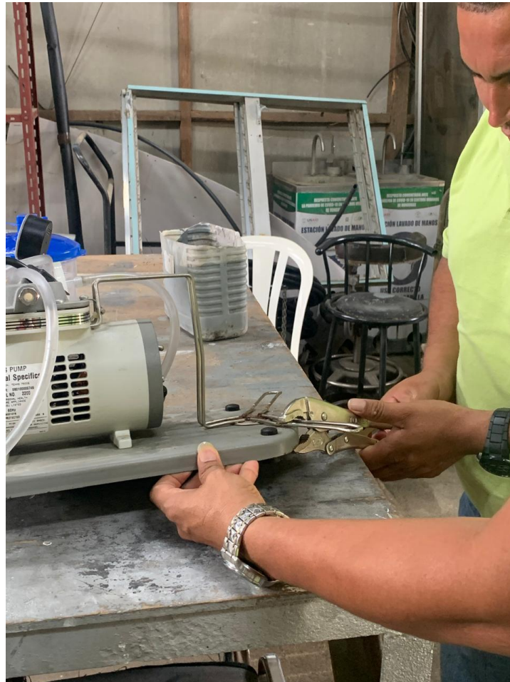
Ilustración 64. Adaptación de estructura de succionador de fluidos
