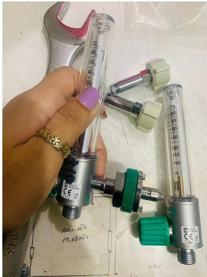
Ilustración 46. Cambio de tipo de adaptador para flujómetro
