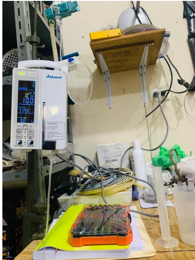
Ilustración 40. Calibración de bomba de infusión
