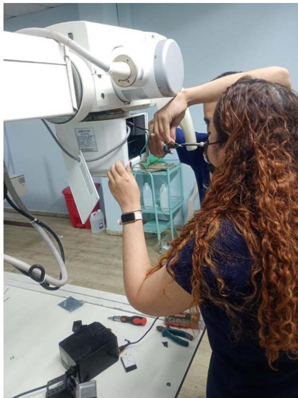
Ilustración 32. Asistencia en reemplazo de led de colimador en máquina de rayos X
