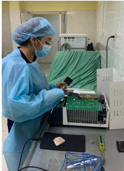
Ilustración 8. Inspección y limpieza de unidad de electrocirugía
