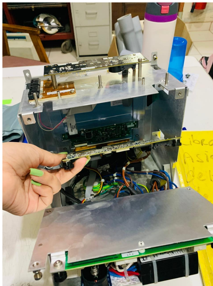
Ilustración 38. Inspección de componentes electrónicos de display de cuna radiante
