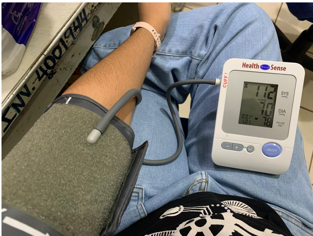
Ilustración 39. Prueba de funcionamiento de brazaletes y esfigmomanómetros
