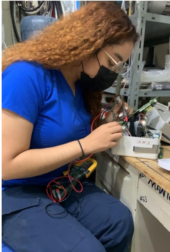
Ilustración 57. Verificación de sensores y conexiones internas de una BI
