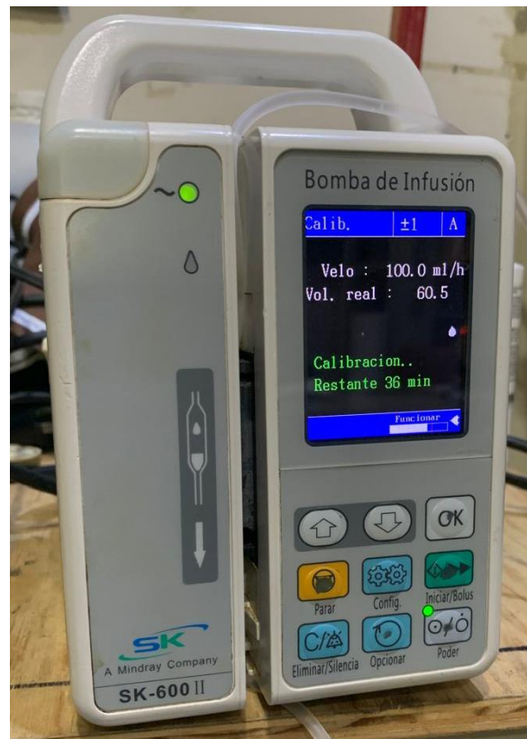
Ilustración 11. Calibración de BI de Sala de Emergencias
