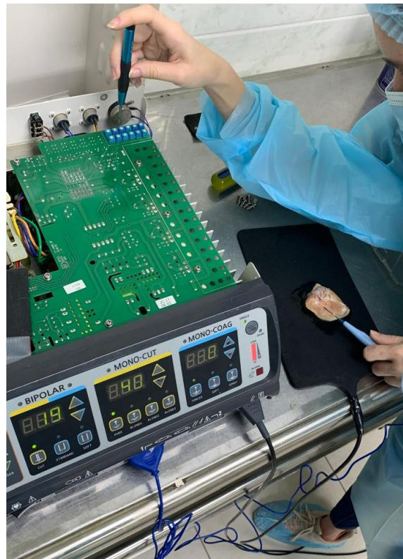
Ilustración 12. Calibración de unidad de electrocirugía
