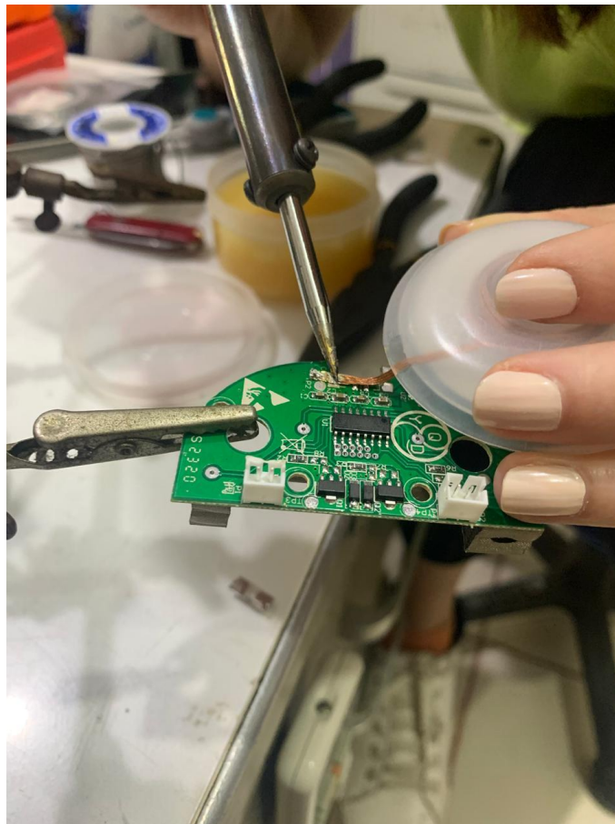
Ilustración 58. Mantenimiento correctivo de extractor de leche materna
