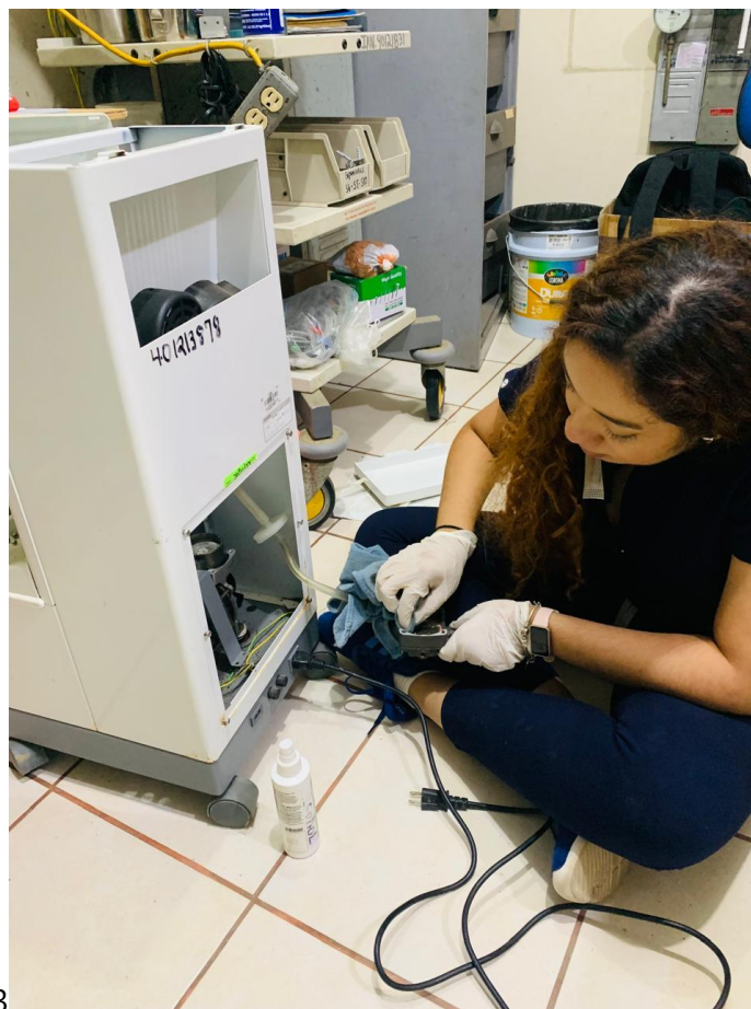
Ilustración 44. Mantenimiento correctivo de succionador de fluidos
