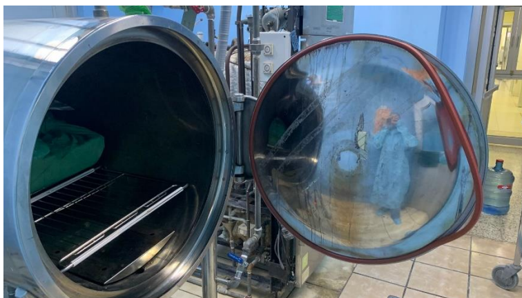
Ilustración 5. Autoclave con empaque en mal estado
