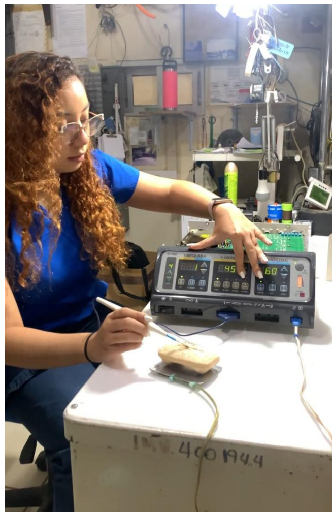
Ilustración 56. Pruebas de potencia de corte y coagulación de ESU
