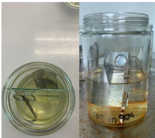
Ilustración 105: Tijera sumergida en solución de cloro al 90% Días 1 (izquierda) y 3 (derecha)
