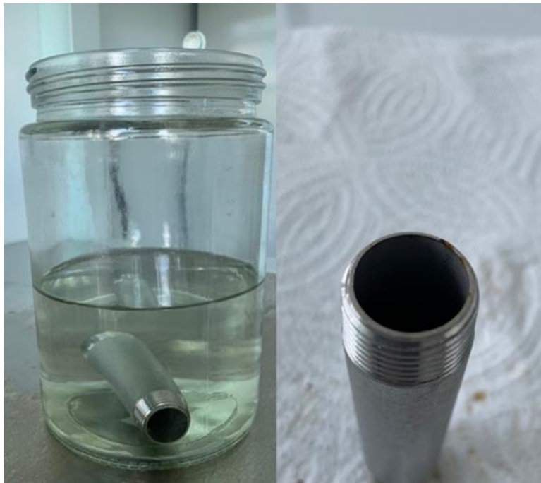
Anexo 8: Medición día 2 y hierro extraído de solución con cloro al 90% elevada.
