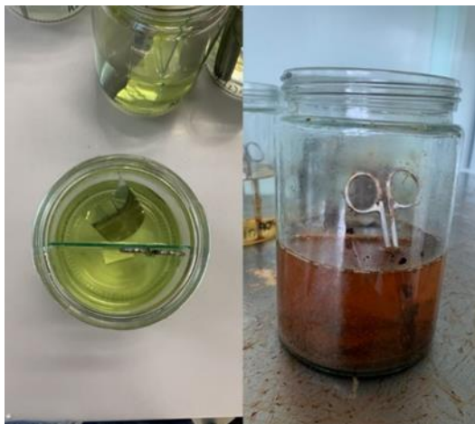
Ilustración 101: Tijera sumergida en solución de cloro al 12% Días 1 (izquierda) y 3 (derecha)
