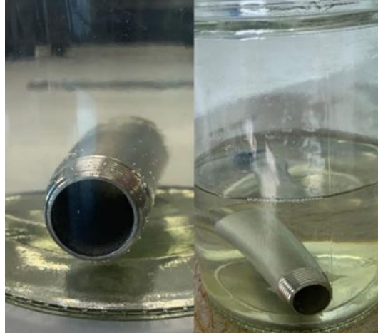
Ilustración 107: Niple sumergida en solución de cloro al 90% elevado
