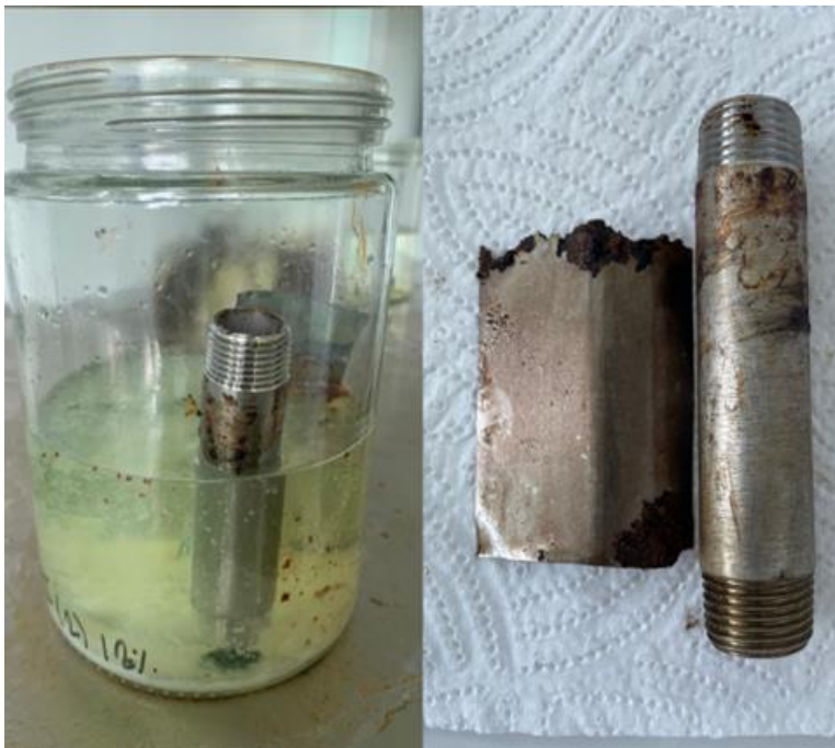
Anexo 2: Medición día 2 y niple extraído de la solución de cloro al 12%.
