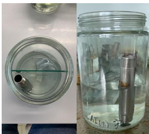
Ilustración 104: Niple sumergida en solución de cloro al 70% Días 1 (izquierda) y 3 (derecha)
