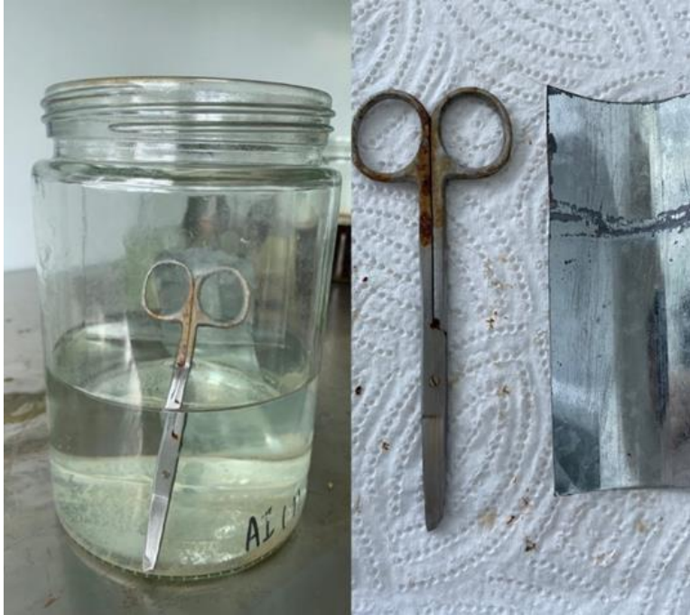
Anexo 4: Medición día 2 y niple extraído de solución de cloro al 70%.
