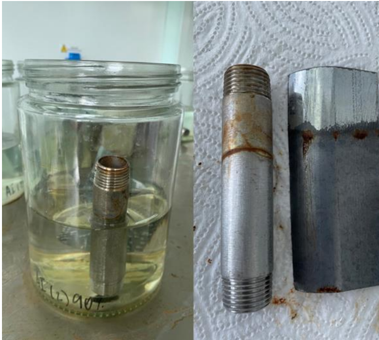
Anexo 6: Medición día 2 y niple extraído de solución con cloro al 90%.
