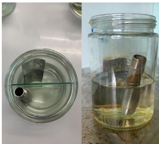
Ilustración 106: Niple sumergida en solución de cloro al 90% Días 1 (izquierda) y 3 (derecha)
