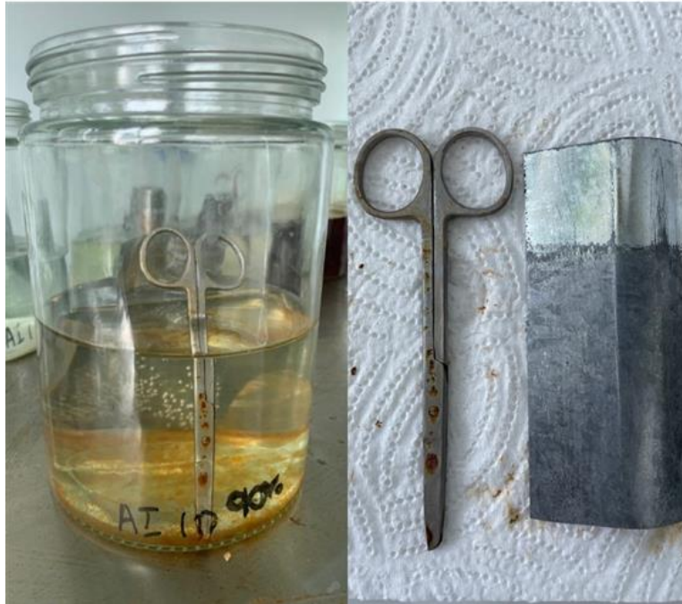
Anexo 6: Medición día 2 y niple extraído de solución con cloro al 90%.
