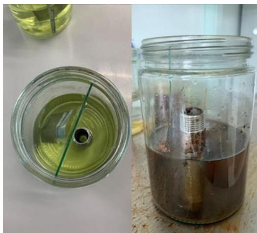
Ilustración 102: Niple sumergida en solución de cloro al 12% Días 1 (izquierda) y 3 (derecha)
