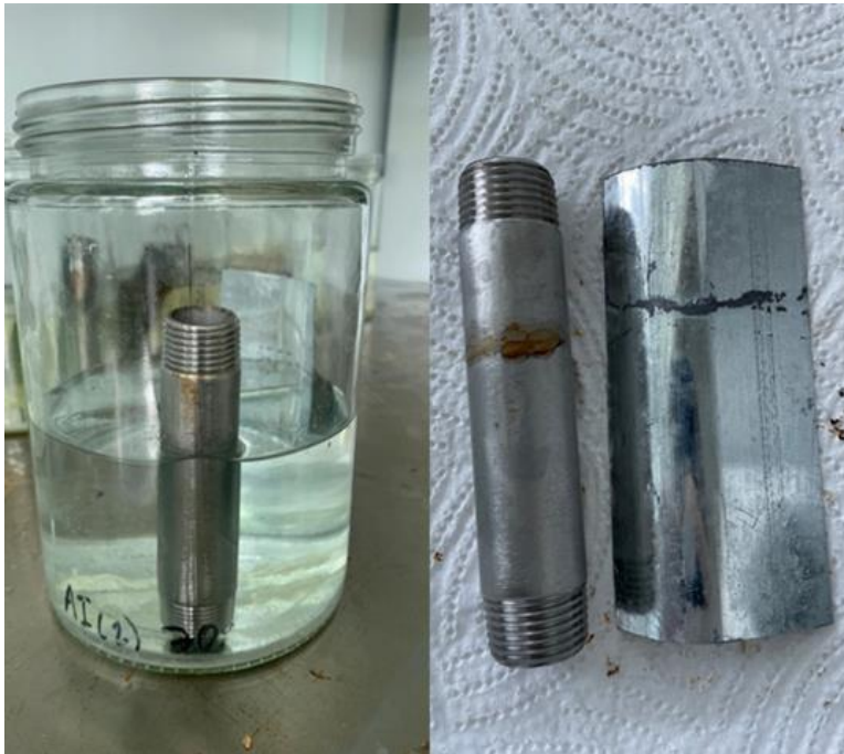
Anexo 4: Medición día 2 y niple extraído de solución de cloro al 70%.
