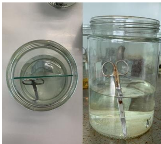
Ilustración 103: Tijera sumergida en solución de cloro al 70% Días 1 (izquierda) y 3 (derecha)
