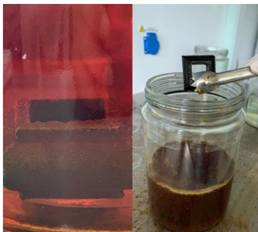
Ilustración 108: Pieza de hierro sumergida en solución de cloro al 90% elevado
