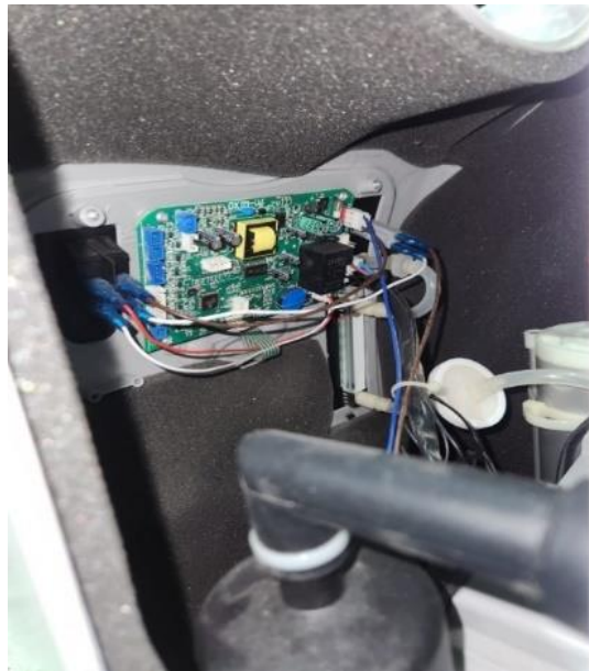
Ilustración 32. Tarjeta principal de concentrador de oxígeno modelo OX-5A.
