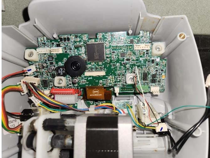
Ilustración 30. Tarjeta principal de bomba de infusión 3ED.
