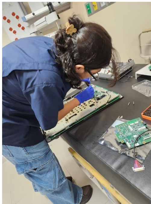
Ilustración 22. Reemplazo de tarjeta de video de MSV.
