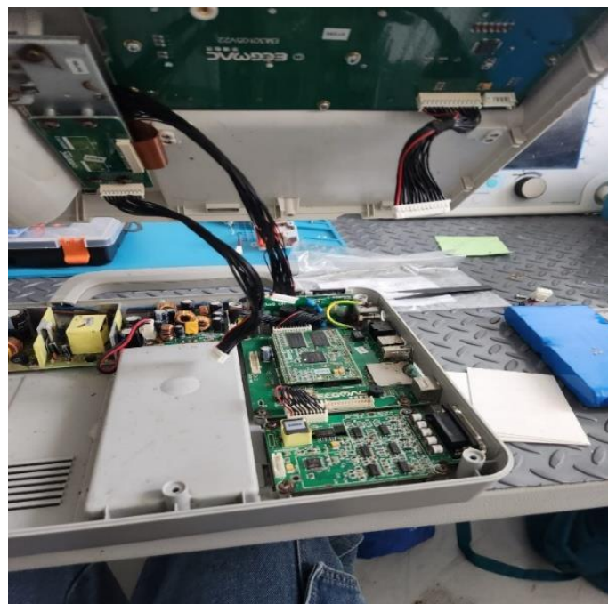
Ilustración 41. Interior de ECG.
