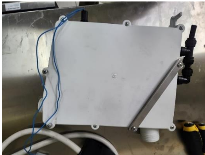
Ilustración 24. Cámara de condensación del MAT LD90.
