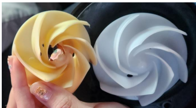
Ilustración 31. Turbina de bomba de lavado de MAT LD90.
