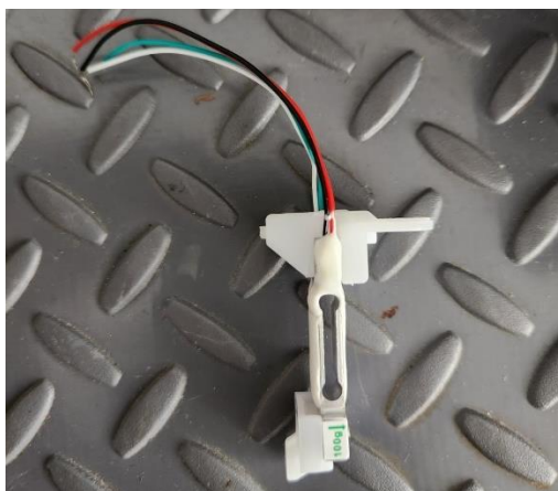
Ilustración 18. Sensor de flujo de bomba de infusión Icatu 3ED.
