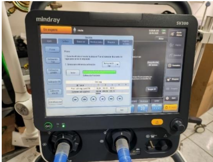
Ilustración 37. Pantalla de calibración de ventilador mecánico Mindray modelo SV300.
