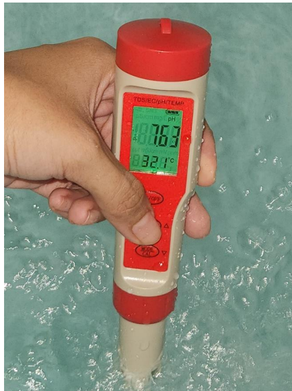
Anexo 6. Prueba de calidad de agua en sistema de tratamiento de agua de autoclave.
