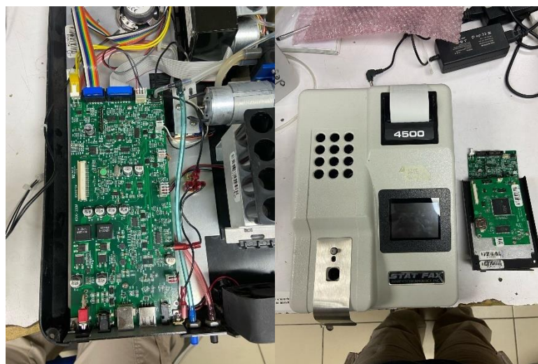
Ilustración 63. Cambio de Placa y Pantalla StatFax 4500
