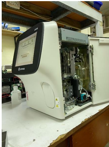
Ilustración 79. Limpieza en válvulas
