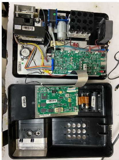
Ilustración 22. Componentes Internos del Statfax 4700
