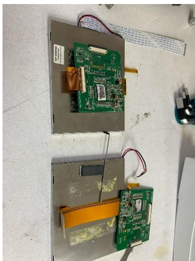
Ilustración 50. Cambio de placa a pantalla en buen estado
