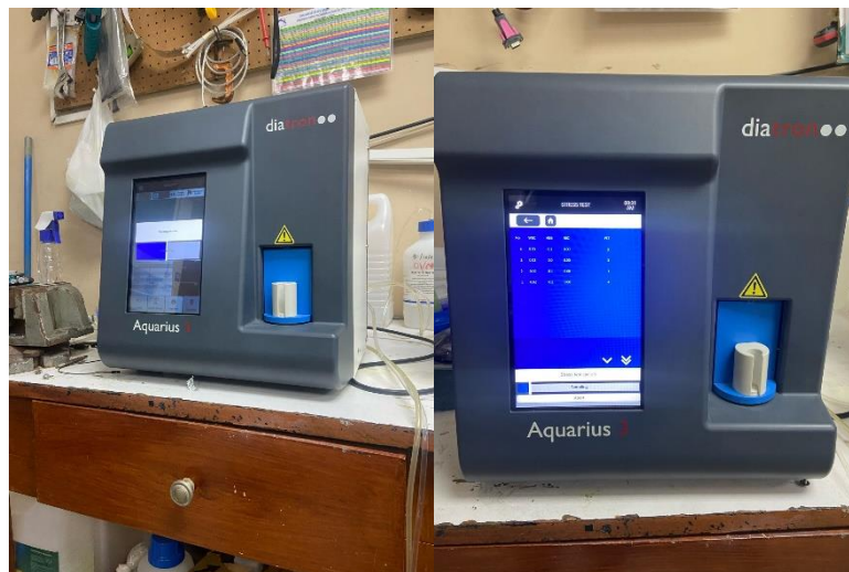
Ilustración 68. Comprobación de funcionamiento de Aquarius 3 luego de cambio de placa SD
