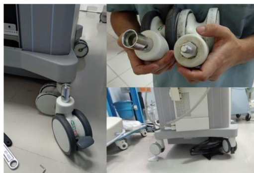
Ilustración 30: Cambio y mantenimiento Preventivo Arco en C
