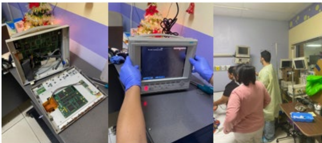
Ilustración 38 - Mantenimiento correctivo de monitor de signos vitales
