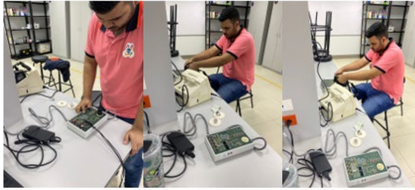
Ilustración 58 - Pruebas de seguridad y funcionamiento de Desfibriladores
