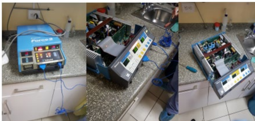
Ilustración 23 - Mantenimiento preventivo y correctivo de un electrocauterio
