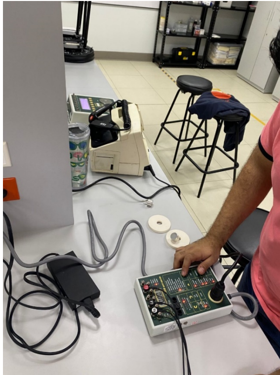
Anexo 1 - Pruebas de seguridad eléctrica en desfibriladores
