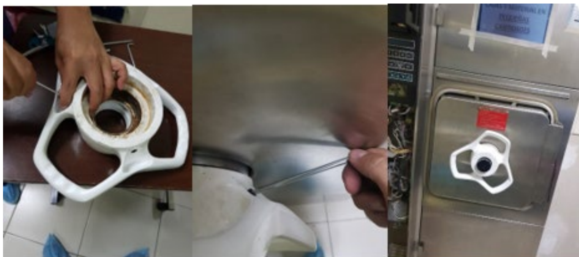
Ilustración 20 - Restauración de volante de autoclave
