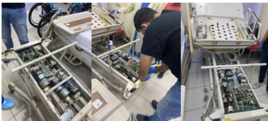
Ilustración 41 - Mantenimiento preventivo de camas hospitalarias
