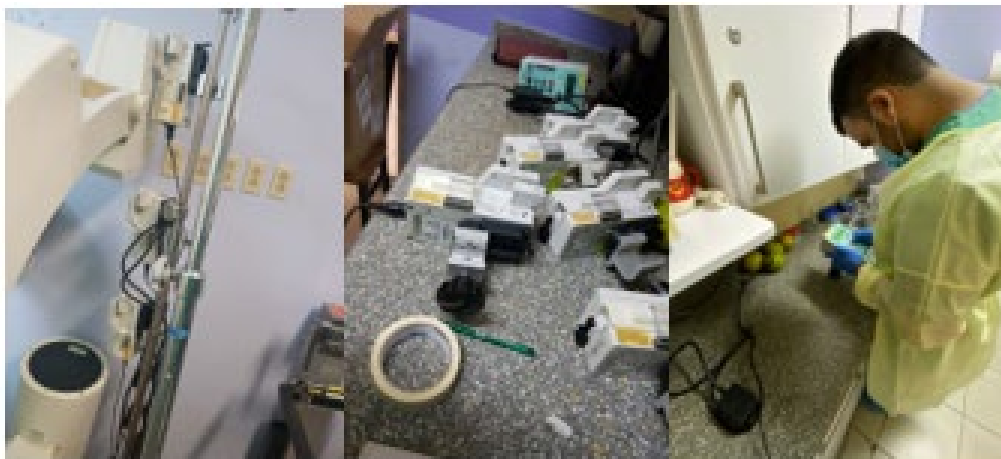
Ilustración 32 - Pruebas de funcionamiento de bombas de infusión
