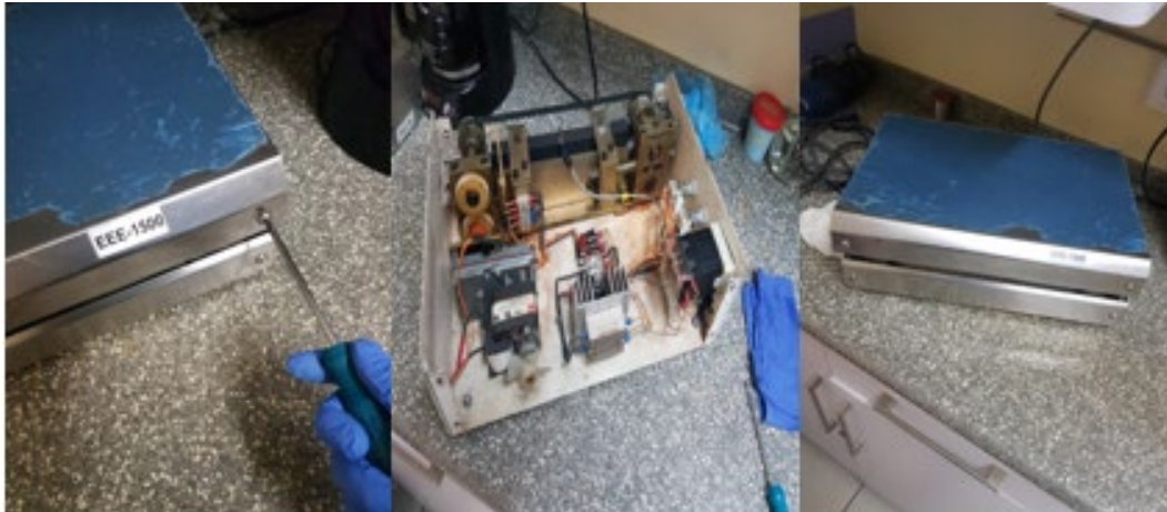
Ilustración 37 - Mantenimiento preventivo de sellador de esterilización
