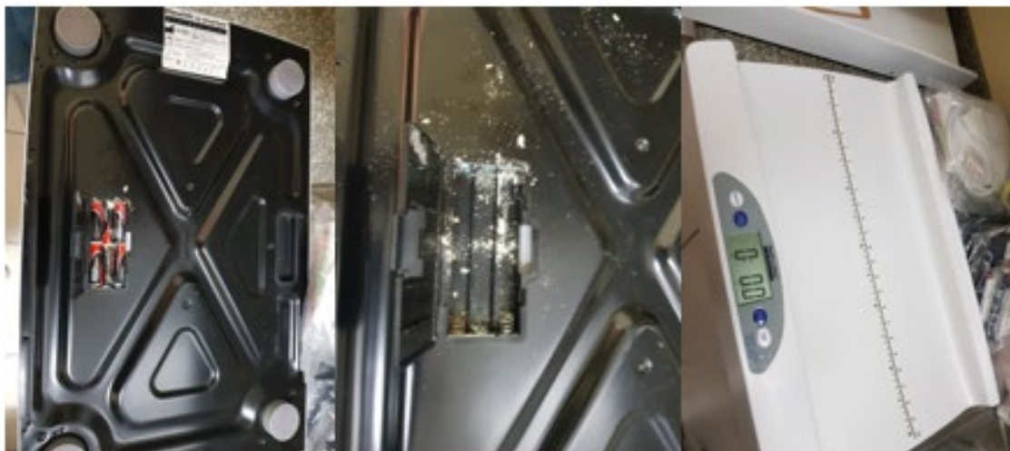
Ilustración 47 - Mantenimiento correctivo de báscula pediátrica
