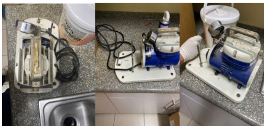
Ilustración 43 - Mantenimiento correctivo de succionador de secreciones
