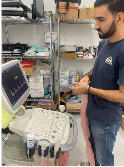
Ilustración 19 Revisión de transductores
