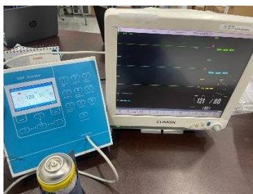
Ilustración 60 Prueba de desempeño MSV
