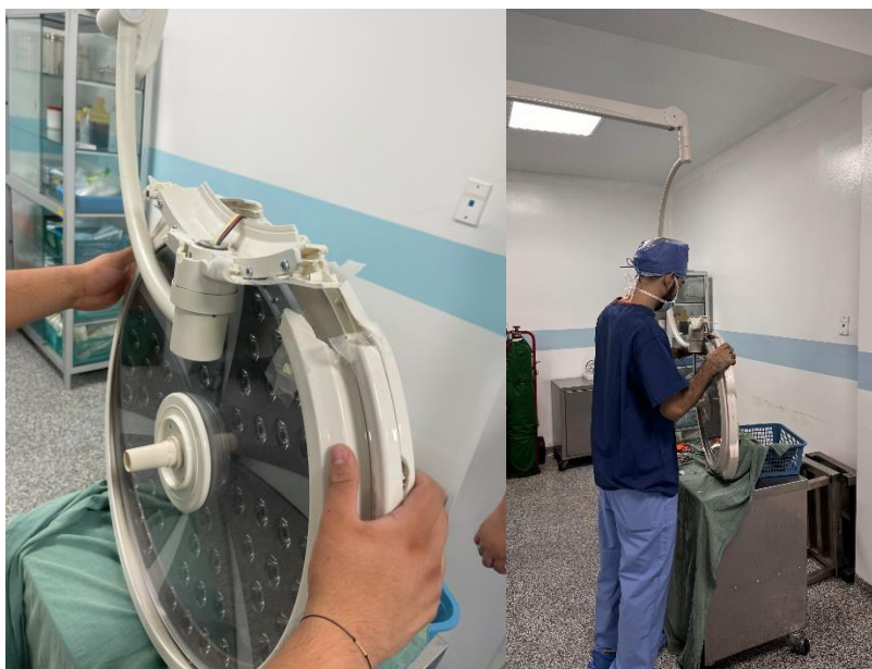
Ilustración 23 Desmontaje de satélite
