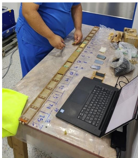
Ilustración 39 Proceso de Shimming.
