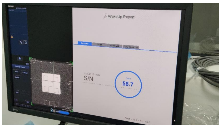
Ilustración 50 Mediciones de SNR en la MRI.
