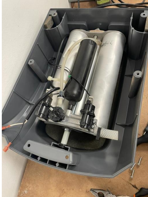
Anexo 3: Zeolitas del concentrador de oxígeno Caire
