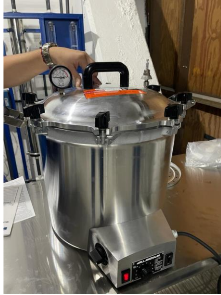
Ilustración 28: Autoclave tipo olla All American
