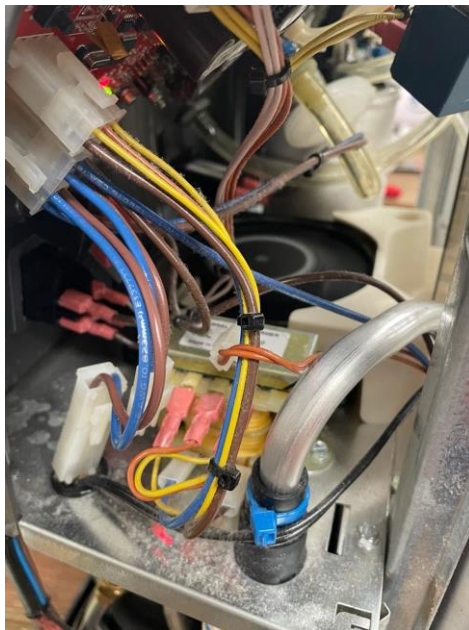
Anexo 6: Tarjeta y circuitos de concentrador Caire
