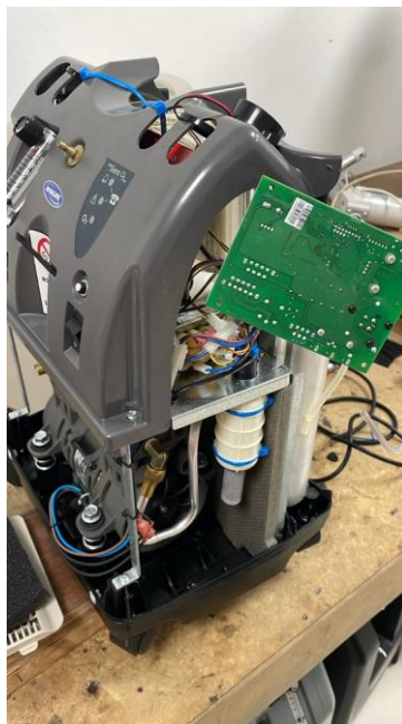
Ilustración 14: Tarjeta y circuitos internos concentrador de oxígeno
