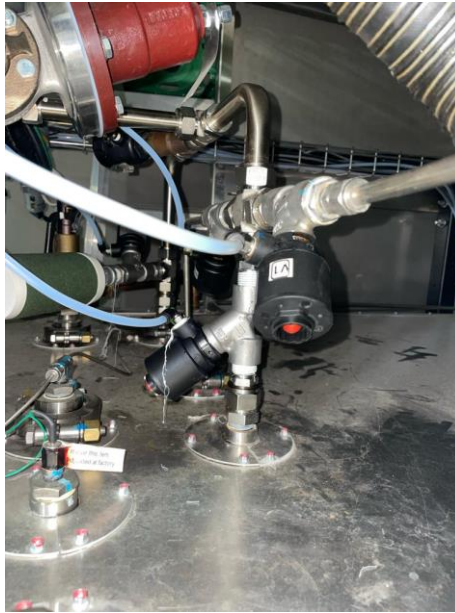
Anexo 9: Válvulas neumáticas autoclave Steris
