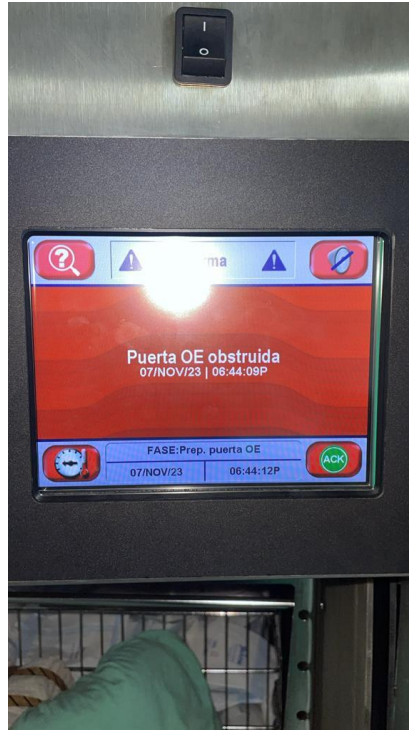
Anexo 11: Alarma del Esterilizador Steris por fallo de puerta
