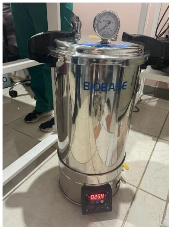
Ilustración 25: Autoclave tipo olla BIOBASE
