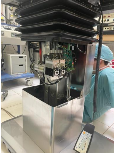
Ilustración 12: Componentes internos de mesa quirúrgica
