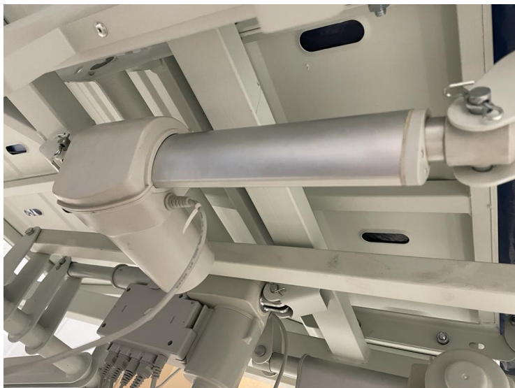
Ilustración 8: Pistón colocado correctamente en cama
