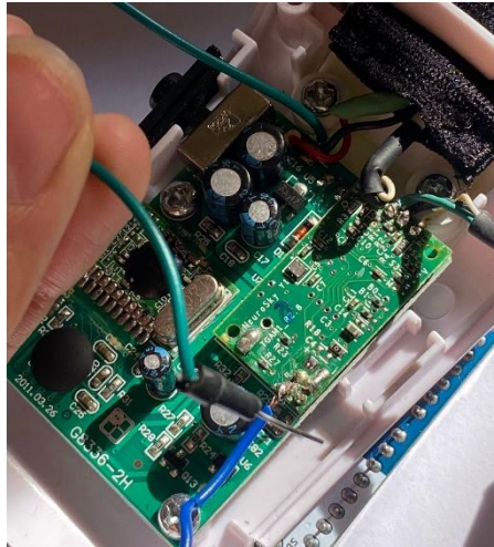
Ilustración 10. Identificación de pines T y R
