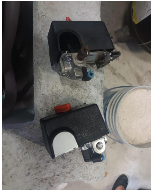
Ilustración 13. Cambió de switch de presión de compresor.
