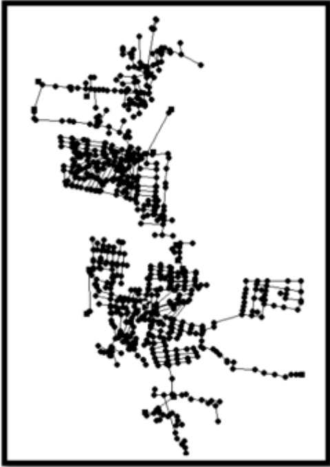
Ilustración 2- Modelado en Epanet del sitio
