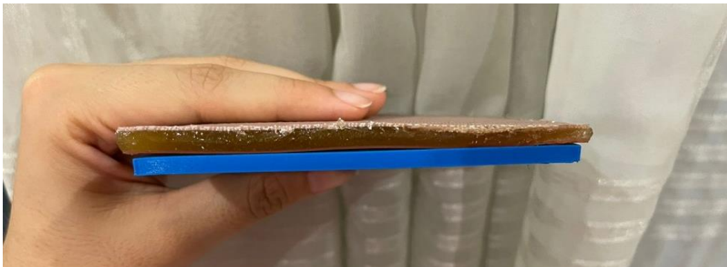
Ilustración 13 Prototipo de silicona adherido al PLA.
