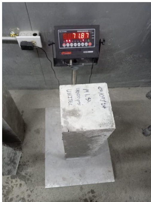
Ilustración 74. Peso de viga de concreto.
