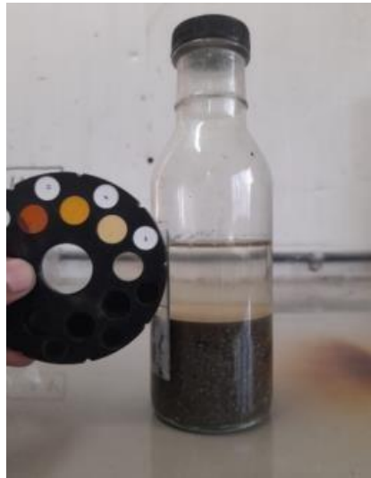
Ilustración 32. Colorimetría de la Arena.
