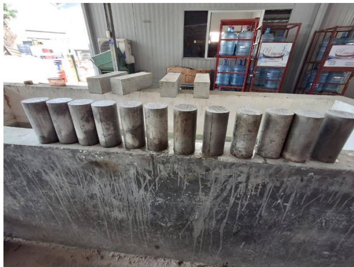
Ilustración 72. Proceso de secado de las muestras de concreto.
