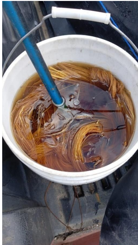
Ilustración 62. Fibra sumergida en agua destilada.
