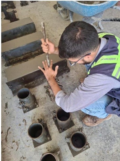
Ilustración 68. Proceso de golpeo a la mezcla de concreto.
