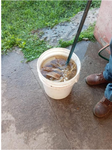
Ilustración 61. Fibra sumergida en la solución de agua e hidróxido de sodio.
