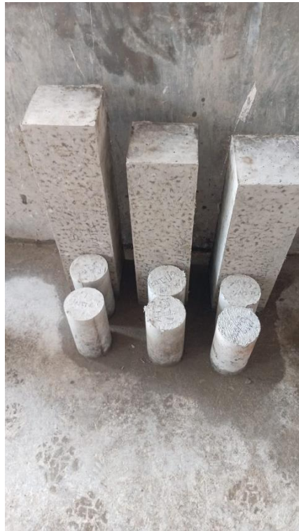
Ilustración 70. Desmolde de las muestras de concreto.
