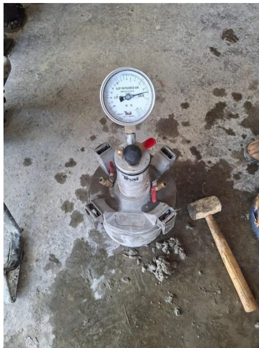
Ilustración 66. Contenido de aire de la mezcla de concreto con fibra de banano.
