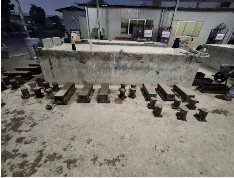
Ilustración 69. Muestras de cilindros y vigas de concreto.
