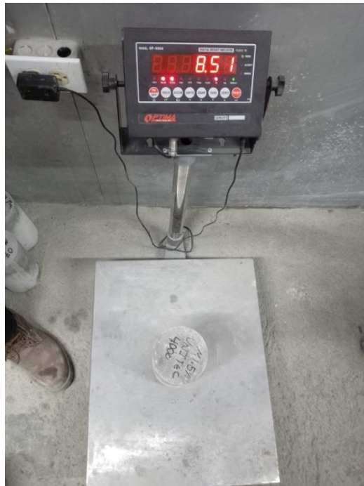
Ilustración 73. Peso de cilindro de concreto.
