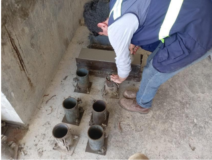
Ilustración 67. Elaboración de especímenes de concreto.
