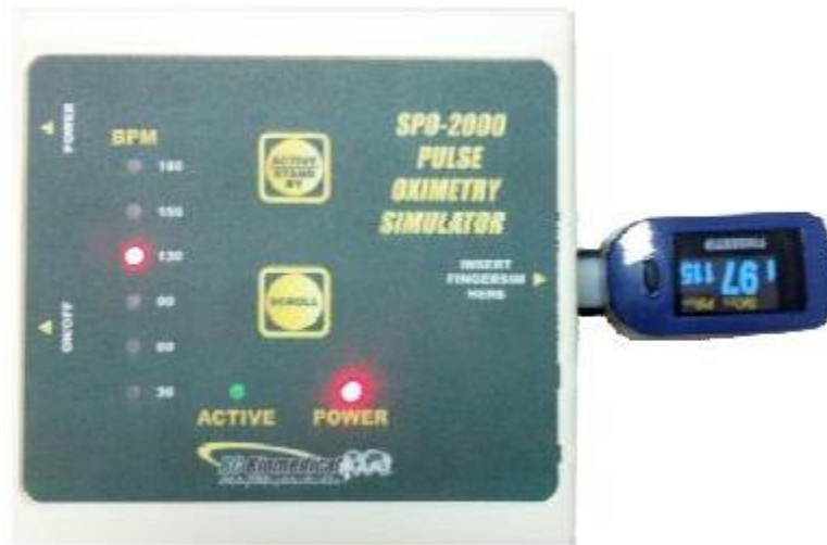
Ilustración 38. Ajuste del simulador con oxímetro de pulso probado
