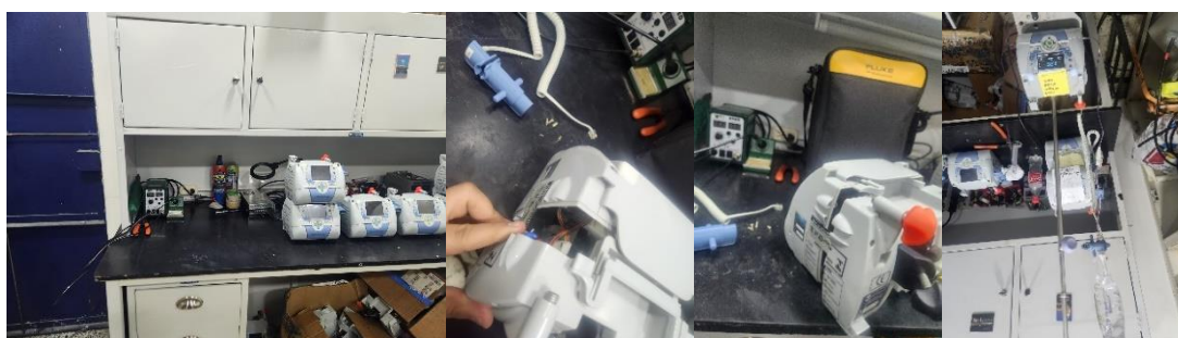
Ilustración 57: Calibración y mantenimiento de bombas de infusión
