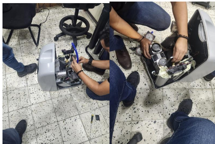
Ilustración 29: Reparación de pistones del concentrador de oxígeno
