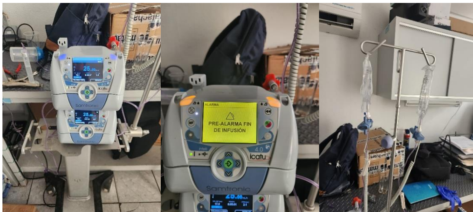
Ilustración 38: Pruebas prolongadas en bombas de infusión
