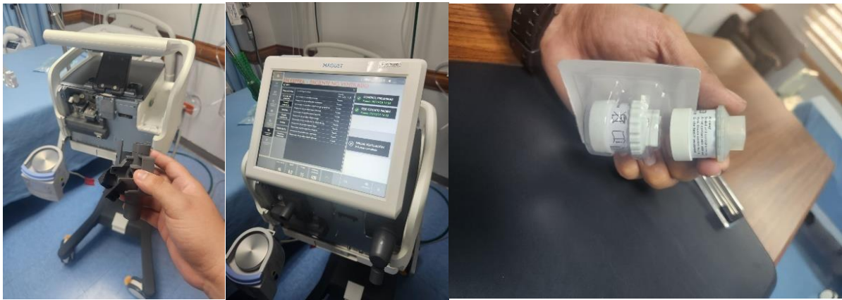
Ilustración 12: Cambio de celdas de oxígeno
