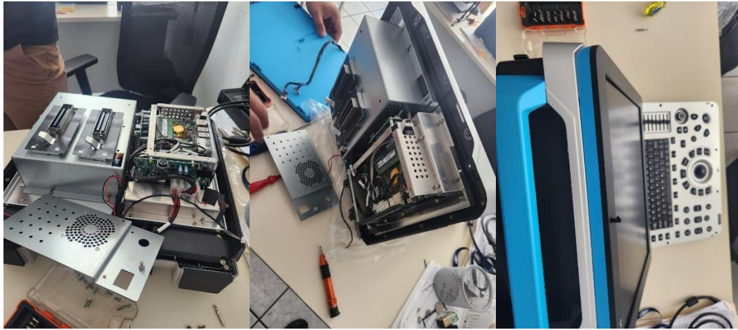
Ilustración 35: Revisión de componentes de ultrasonido
