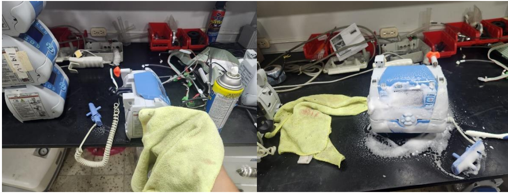
Ilustración 17: Limpieza de Bombas de Infusión
