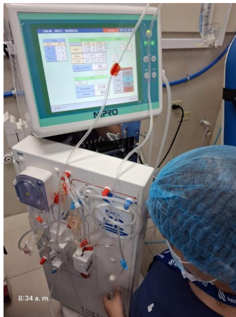
Ilustración 12: Calibración de sensor de aire
