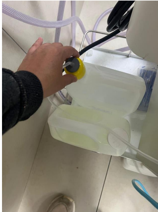
Ilustración 17: Cambio de Pipetas para Desincrustación
