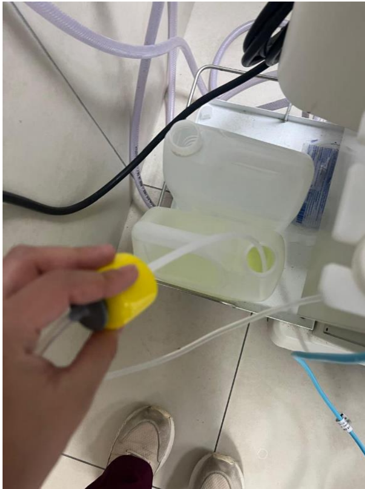
Ilustración 16: Cambio de Pipetas para Desincrustación
