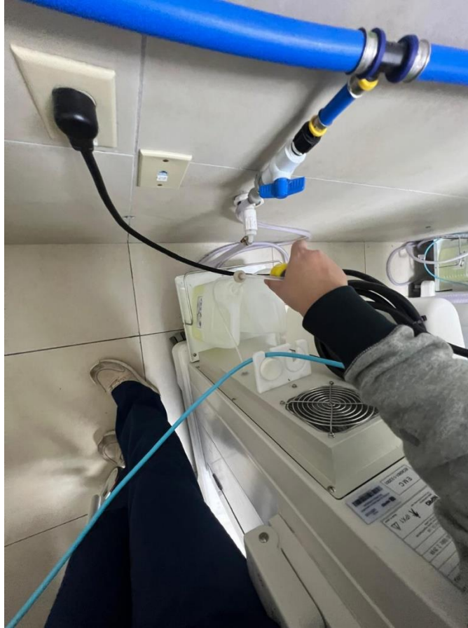
Ilustración 22: Cambio de pipeta para desincrustación de máquina
