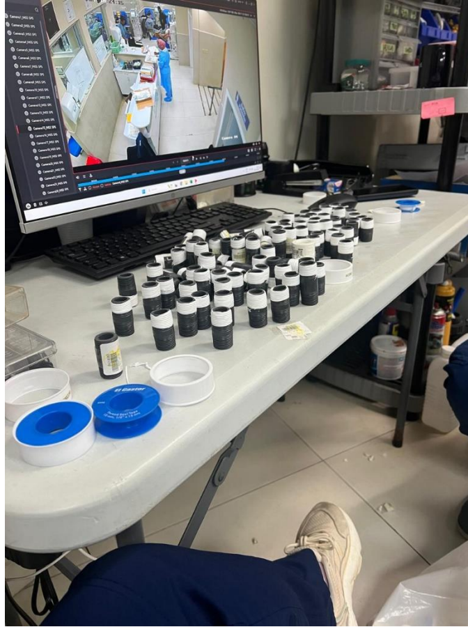
Ilustración 28: Colocación de teflón a tubos
