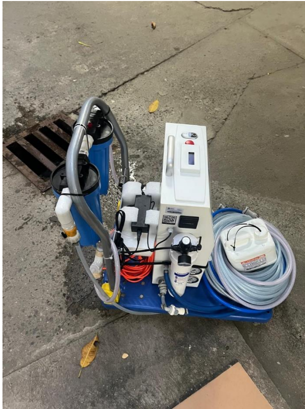
Ilustración 24: Ósmosis portátil trasladada a sala de observación
