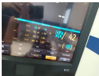
Ilustración 23 MSV con falla en medición de presión.
