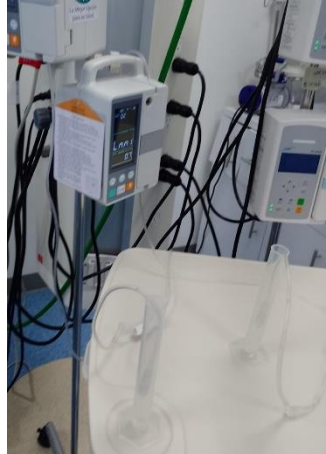
Ilustración 31 Calibración de bombas de infusión.
