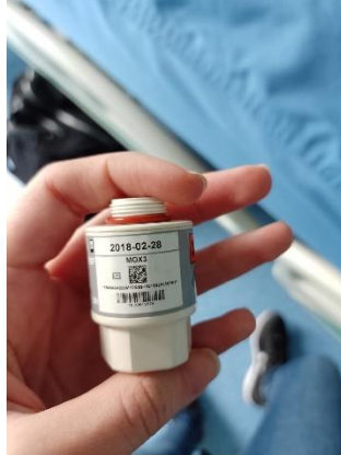
Anexo 7 Celda de O2 vencida de ventilador mecánico.
