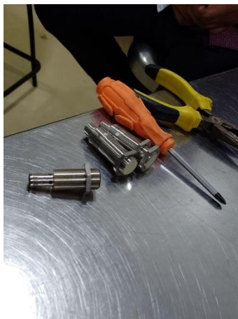
Anexo 6 Sensores de puerta frontal y trasera del esterilizador CASTLE.
