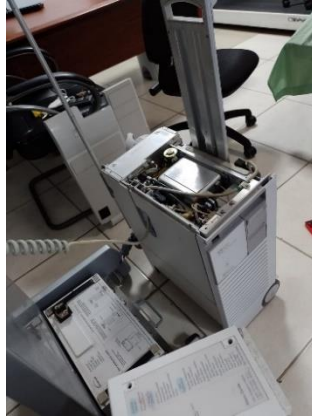
Ilustración 17 Desinstalación de Datascope CS100 para realizar reemplazo de paquete de baterías.
