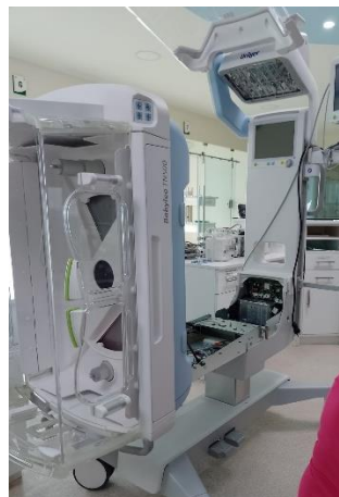
Ilustración 30 Reinstalación de placas en incubadora neonatal.
