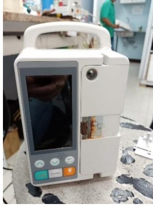
Ilustración 27 Bomba de infusión con falta de retenedor de puerta.
