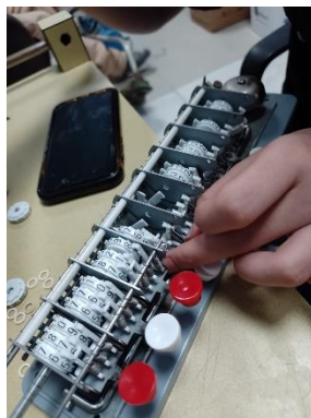
Ilustración 43 Reparación de contador de células.
