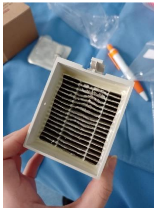
Anexo 8 Filtro de aire de ventilador mecánico.
