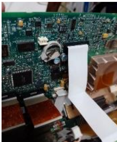
Ilustración 25 Placa del sistema en desfibrilador Zoll.
