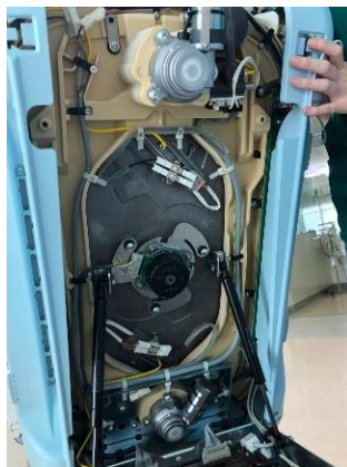
Ilustración 28 Parte interna de incubadora Dräger Babyleo TN500.
