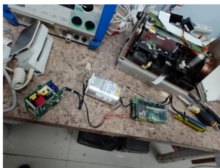
Ilustración 22 Módulo de alto voltaje de desfibrilador Zoll.
