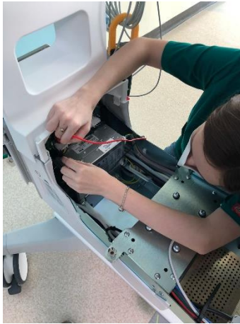
Ilustración 29 Revisión de componentes internos de incubadora neonatal.
