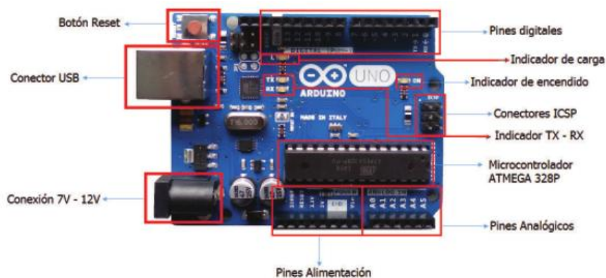
Figura 4.9 Partes de Arduino Uno R3
